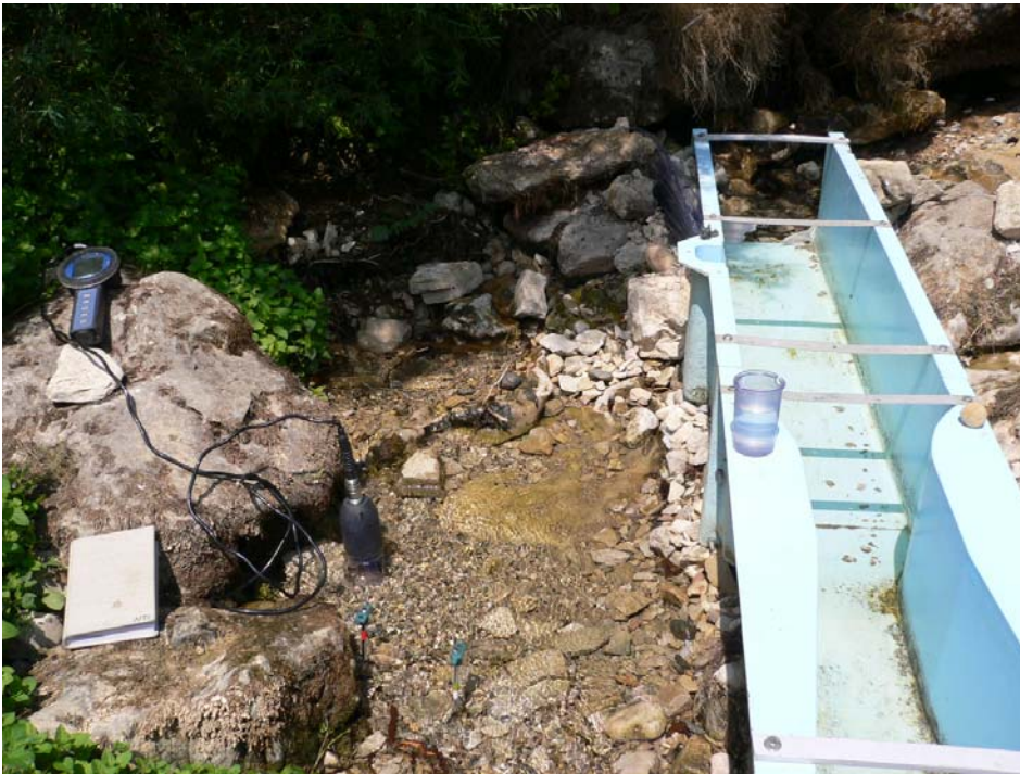
Illustration 5 : Seuil calibré de jaugeage installé au niveau du griffon N°4 des Cent Fonts en rive droite de l'Hérault
