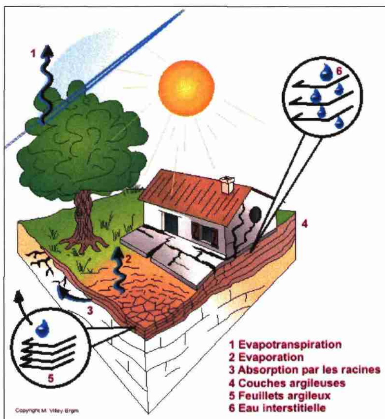
Illustration 1 – Schématisation de la dessiccation des sols argileux en période sèche
