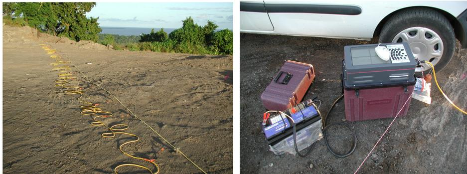
Figure 8 : Dispositif SASW utilisé à Mayotte (à gauche : « flûte » de géophones, à droite : station d'acquisition).
