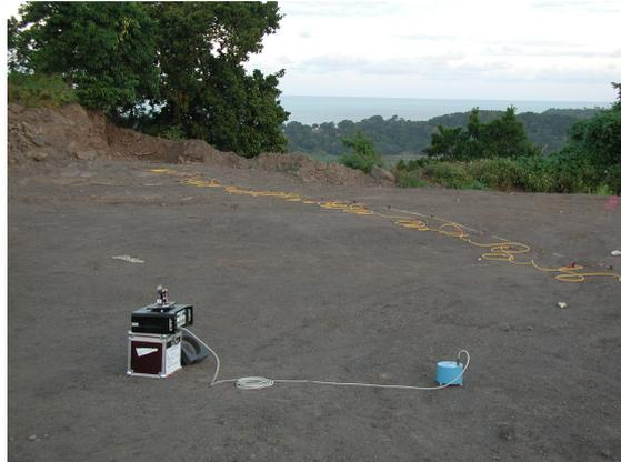
Figure 7 : Dispositif H/V utilisé par le BRGM à Mayotte (à gauche : la station d'acquisition et à droite : le sismomètre tridimensionnel 5 secondes).
