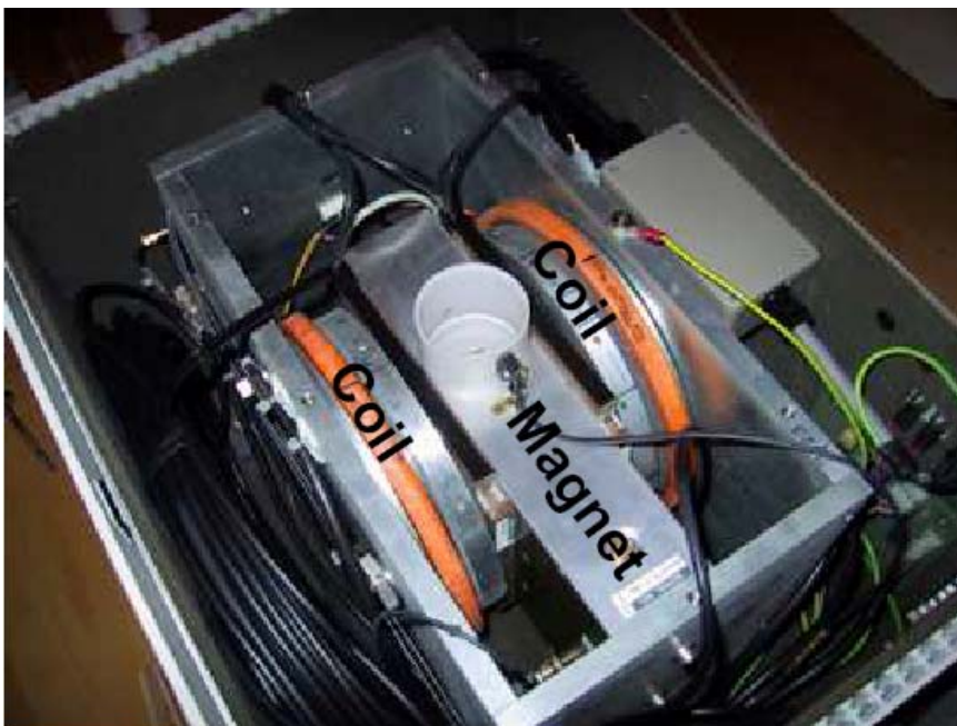
Figure 9 - Vue à l'intérieur du Maran Ultra 2 MHz. Au milieu la place pour les échantillons (en blanc) avec des deux cotés l'aimant permanent et les bobines émettrices/receptrices (en rouge) (d'après Kooman, 2003).
