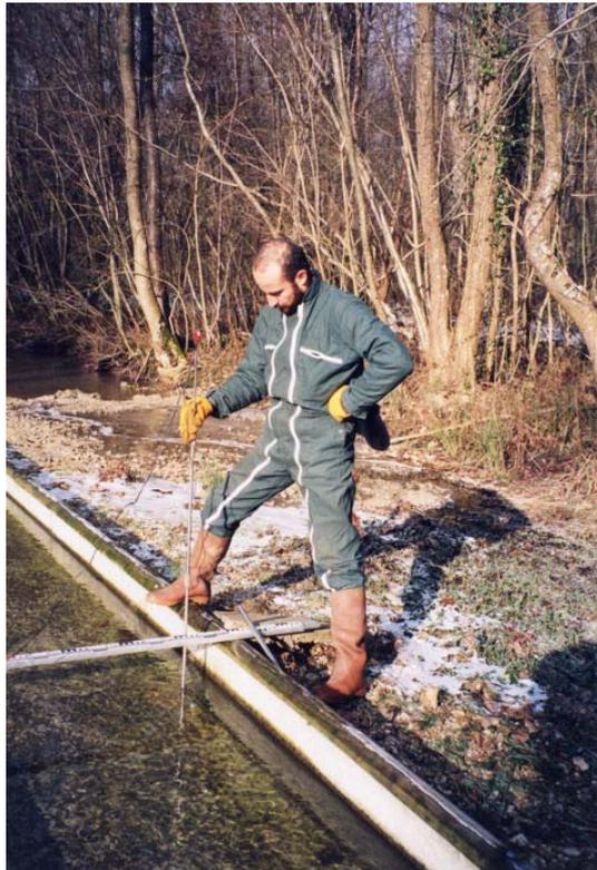
*Illustration 3 - Réalisation d'un jaugeage au micromoulinet.*
