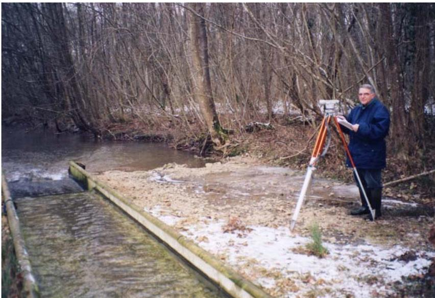
*Illustration 4 - Mesures topographiques pour l'établissement d'un profil en travers et le calage du repère de mesure par rapport à la crête du seuil.*
