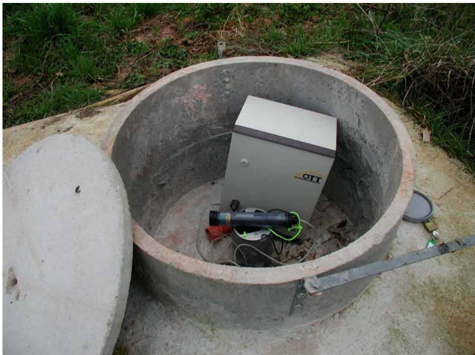
Figure 16 - Photographie du matériel GSM après mise en place (site de La Noë Blanche)
