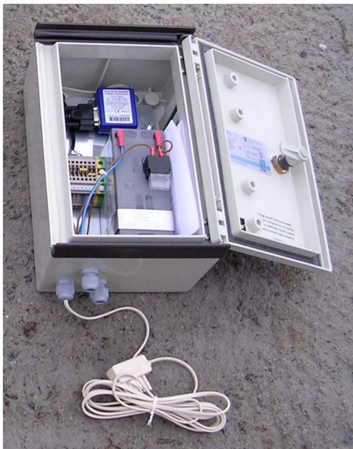
Figure 11 - Photographie d'un boîtier de protection RTC
