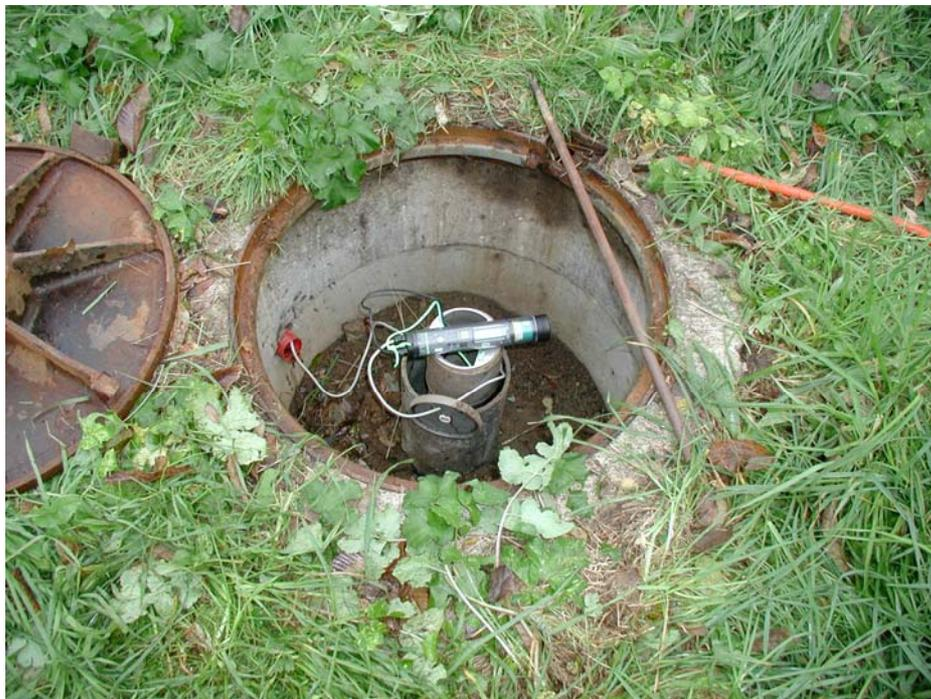
Figure 13 - Photographie de centrale d'acquisition après mise en place (site de Landrévarzec)
