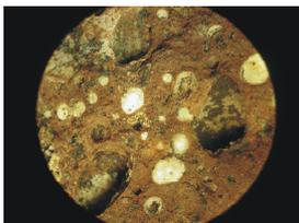
Vue à la loupe binoculaire d'un échantillon du toit de coulée scoriacée (3). On distingue les nombreuses vacuoles, quelques baguettes de pyroxène ainsi qu'un phénocristal de pyroxène altéré.
