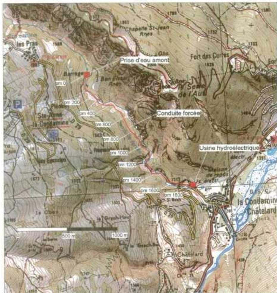
Figure 1 – Implantation de l'installation hydroélectrique – Extrait de la carte IGN au 1/25 000
