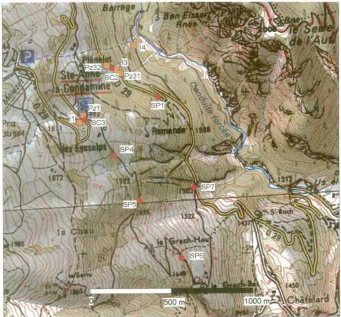
Figure 4 – Implantation des sondages d'archives (en rouge sondages FONDASOL – en orange, sondages CEBTP)
