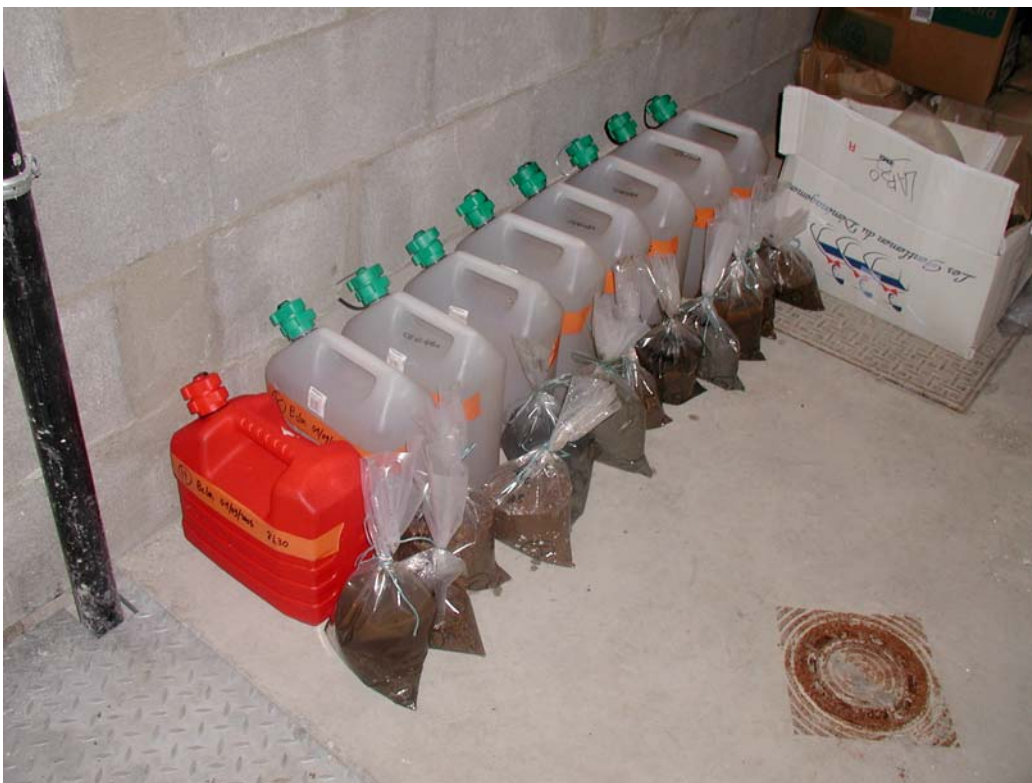
Aperçu des prélèvements d'eau (bidons 10 L pour analyses granulométriques des MES) et de sédiment (échantillons de 1 kg pour analyses granulométriques et chimiques)
