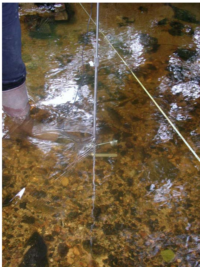
Aperçu de l'hélice du micromoulinet
