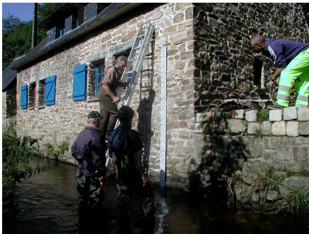
Aperçu de l'échelle limnimétrique de 3 m à Moulin Nézet (Belon)
