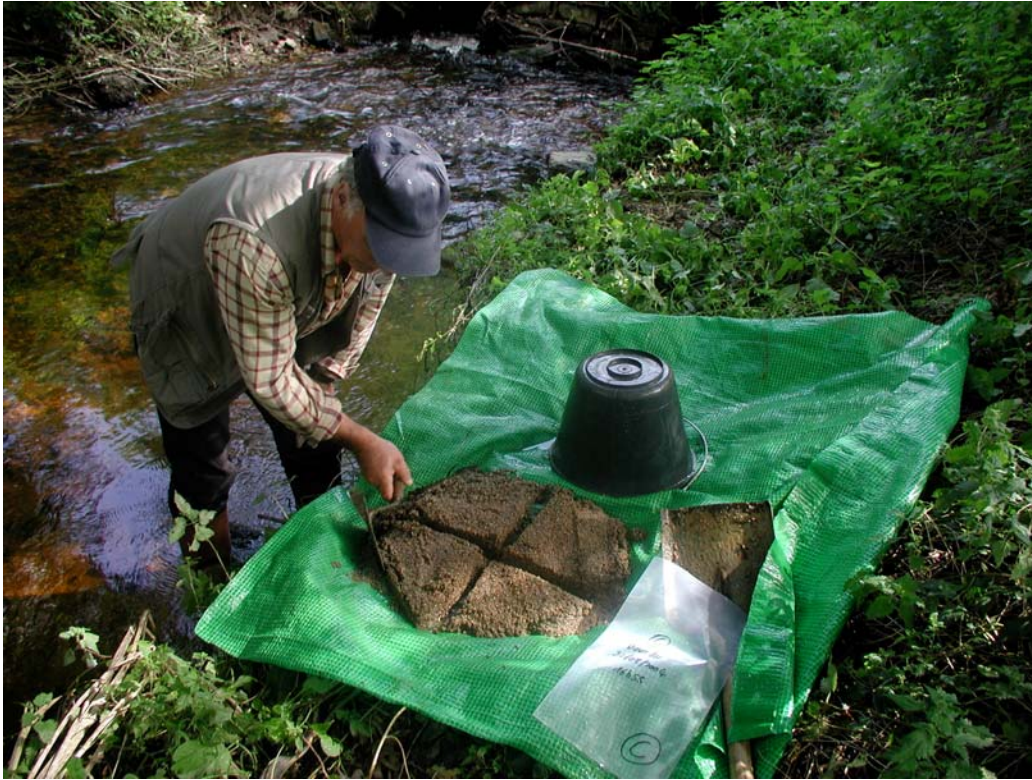
Echantillonnage par quartage du sédiment de fond de rivière au point C (Pont Bellec)
