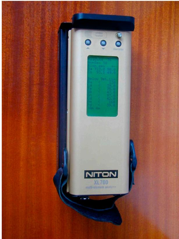
Illustration 3 - Spectromètre de fluorescence X portable (Niton XL723S) de la série XL700 équipé de deux sources radioactives de Cd<sup>109</sup> et Am<sup>241</sup>.
