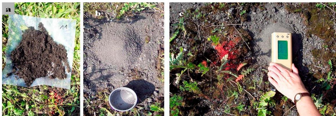
Illustration 40 - Mode de mesure sur site après homogénéisation du prélèvement (a), tamisage à 2 mm (b) et analyse (c).
