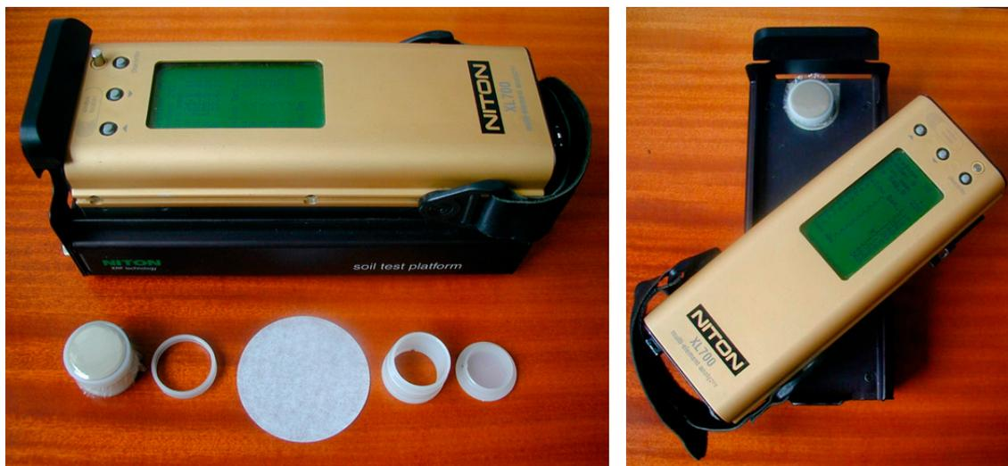
Illustration 6 - Analyse des échantillons par spectrométrie de fluorescence X (mode laboratoire).
