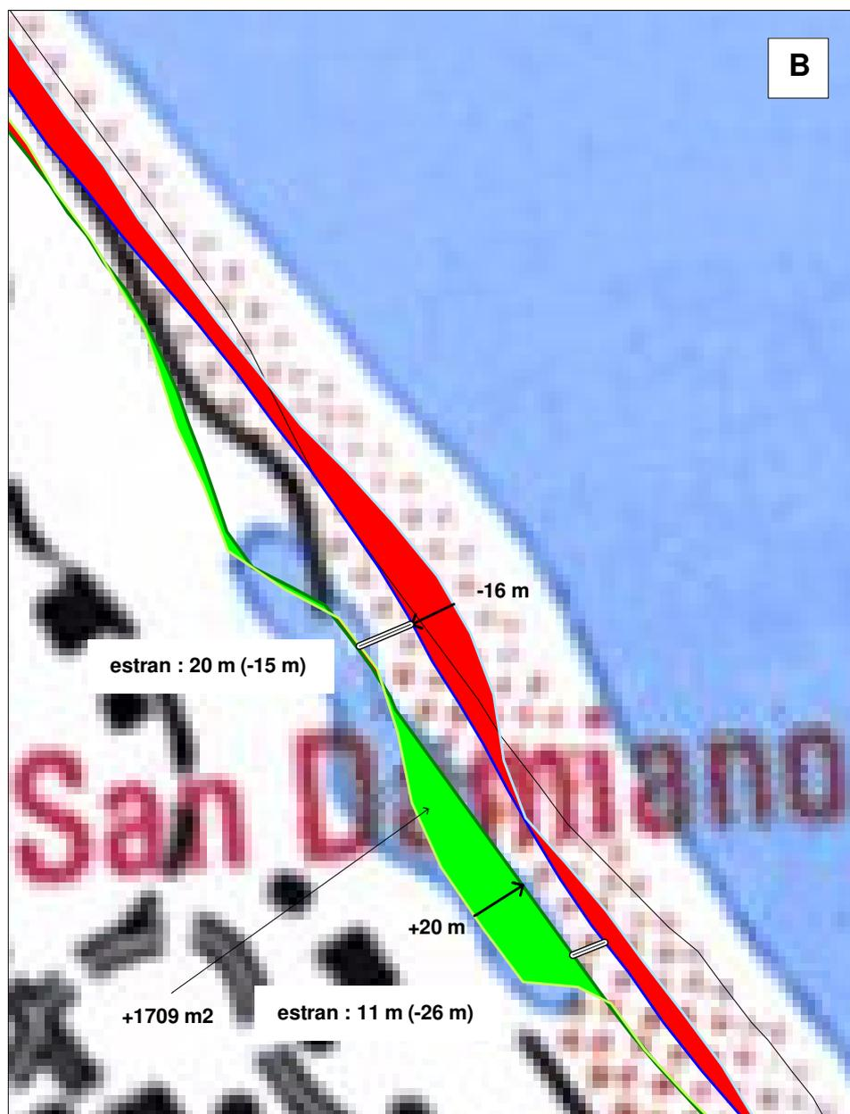
**Fig. 49 - Site Lido de la Marana, levés DGPS – 19/02/2002 et 13/02/2003 : zoom sur la zone B (camping San Damiano). En rouge, les surfaces en érosion ; en vert, les surfaces en accréation.**
