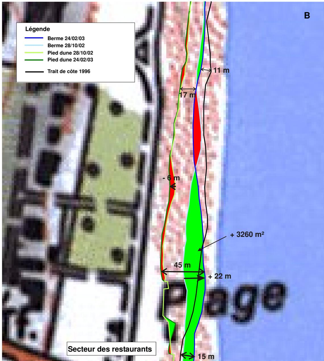
**Fig. 10404- Site Tavignano, levés DGPS – 28/10/2002 et 24/02/2003 : zoom sur la zone Padulone. En rouge, les surfaces en érosion ; en vert, les surfaces en accrétion.**
