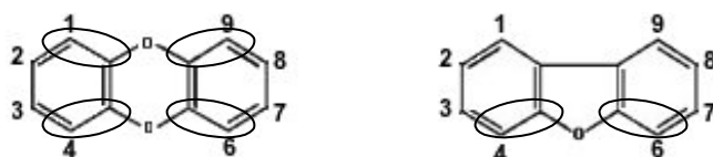
Fig. 9 - Positions atomiques non chlorées concernées par la dioxygénation sélective sur les molécules de PCDD/F (cercles)
