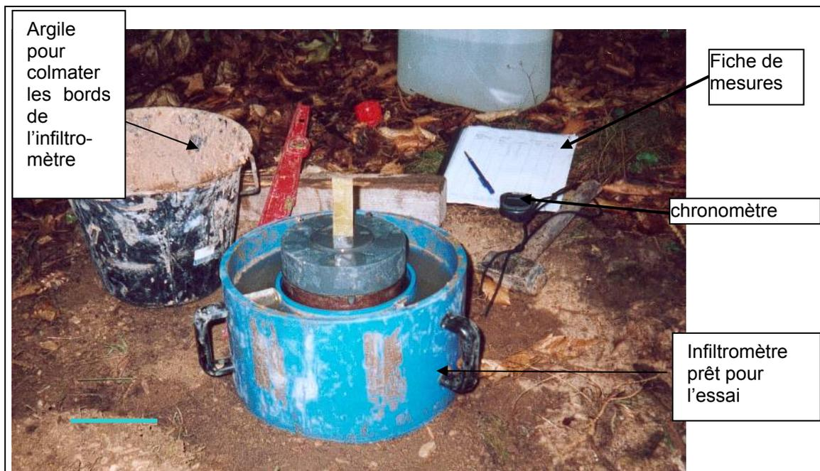
**Photographie de l'appareil de mesure.**
