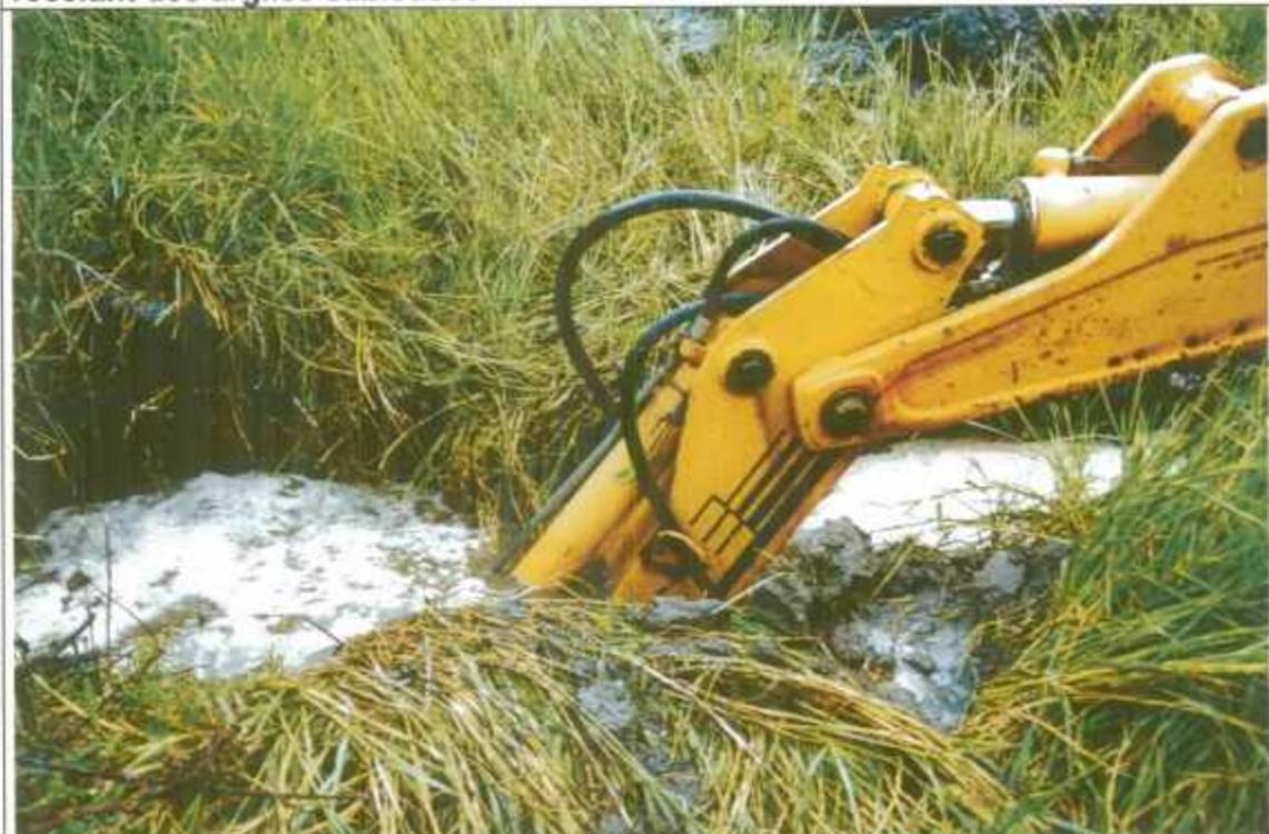
**Photographie 10 : Site de Savannah (commune de Saint-Paul) – Prélèvement au tracto-pelle d'un échantillon d'argile alluviale sous la nappe phréatique**
