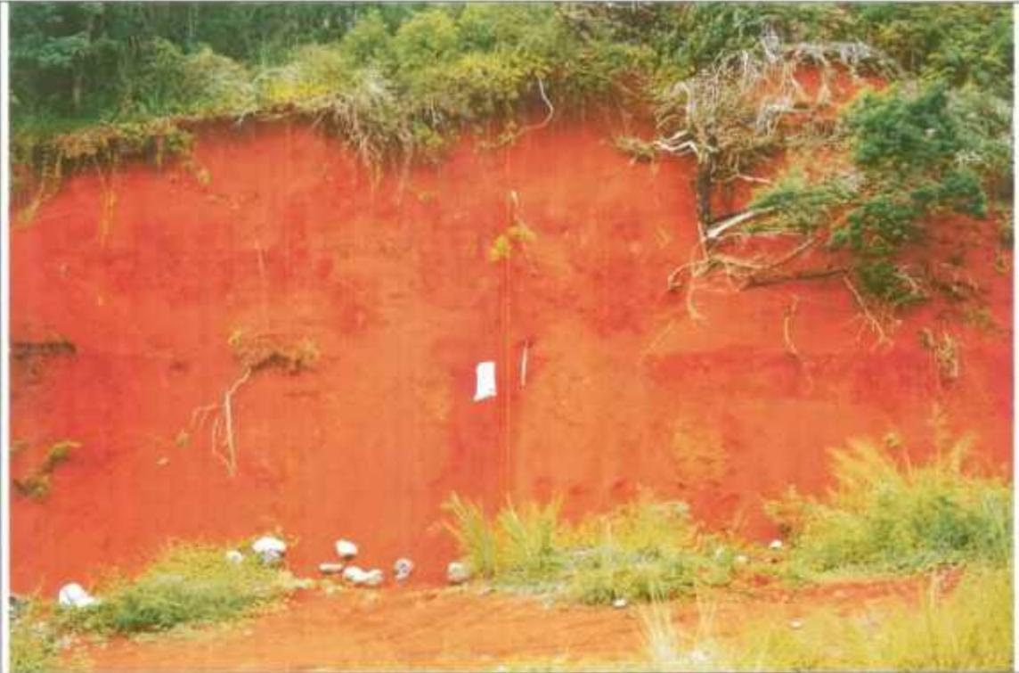
**Photographie 1 : Argile d'altération de Piton Rouge (commune des Aïrons) – Front de taille d'une ancienne carrière**
