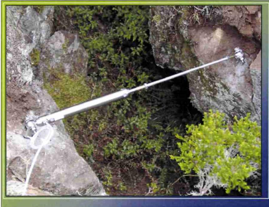
Ce capteur est équipé d'une rallonge. Il est situé le plus près du bord de la falaise (voir plan d'implantation de la figure 4)
