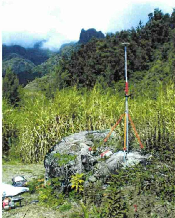
Mesure de positionnement à partir d'un repère sur bloc (point sa 48)
