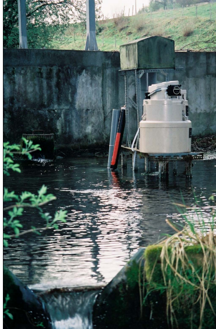
Illustration 3 - Source des Trois Fontaines – vue du préleveur automatique et de la sonde multiparamètre.
