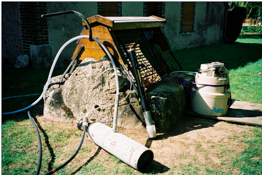
Illustration 7 - Puits des Glandons – vue de la sonde multiparamètre, du préleveur à gaz et du préleveur automatique.
