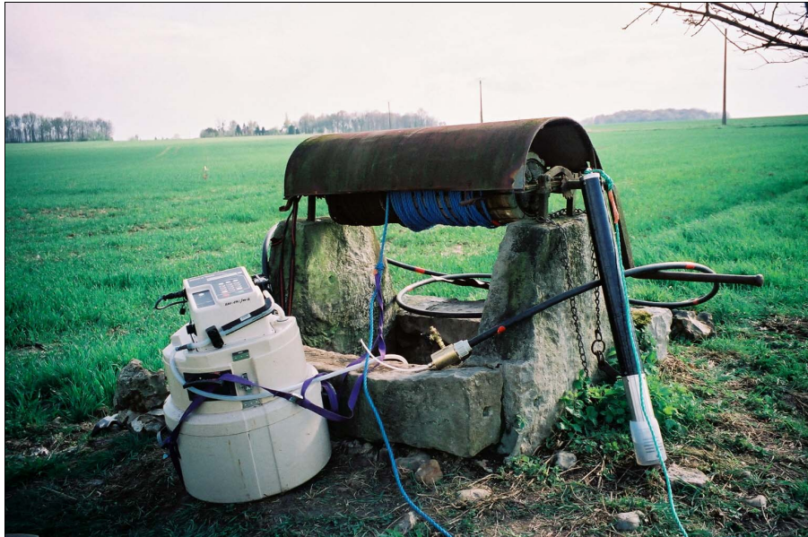
Illustration 6 - Puits de la Bissaugerie – vue de la sonde multiparamètre, du préleveur à gaz et du préleveur automatique.
