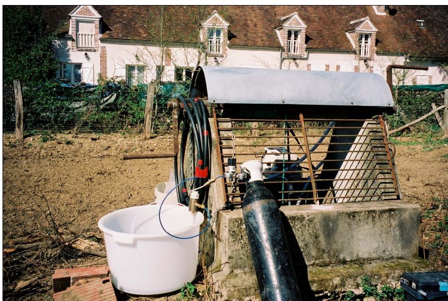
Illustration 9 - Puits des Grands Pressoirs – vue de la sonde multiparamètre, du préleveur à gaz et du préleveur automatique.
