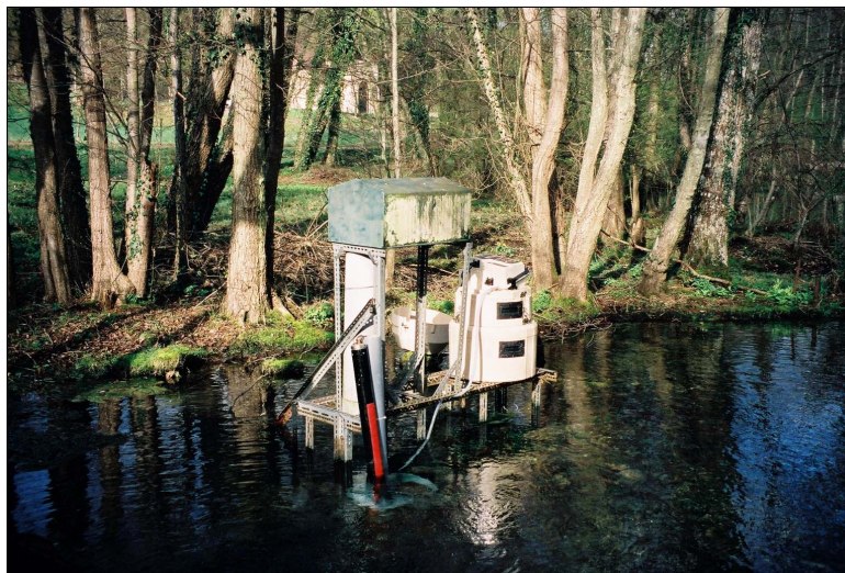
Illustration 4 - Source des Trois Fontaines – vue du préleveur automatique et de la sonde multiparamètre.
