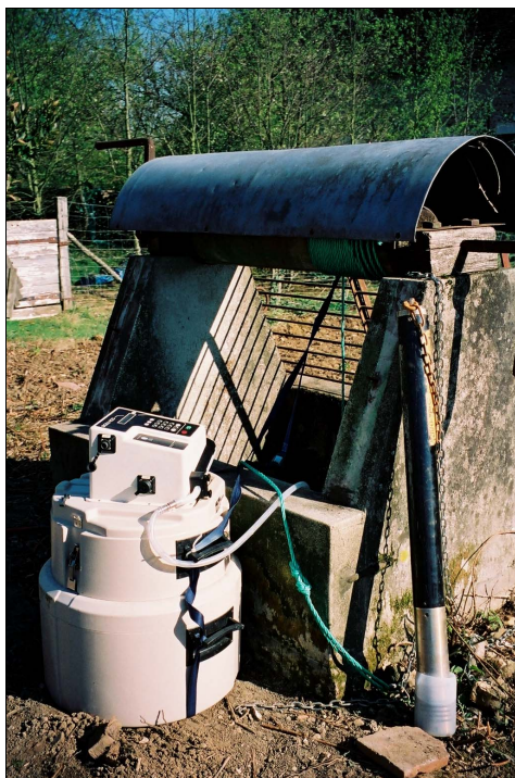
Illustration 8 - Puits des Grands Pressoirs – vue de la sonde multiparamètre et du préleveur automatique.
