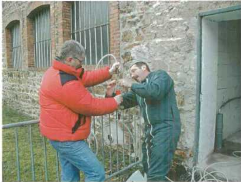
Figure 21 - Echantillonnage en sortie du piquage sur pompage du puits "Brault 3 nouveau"
