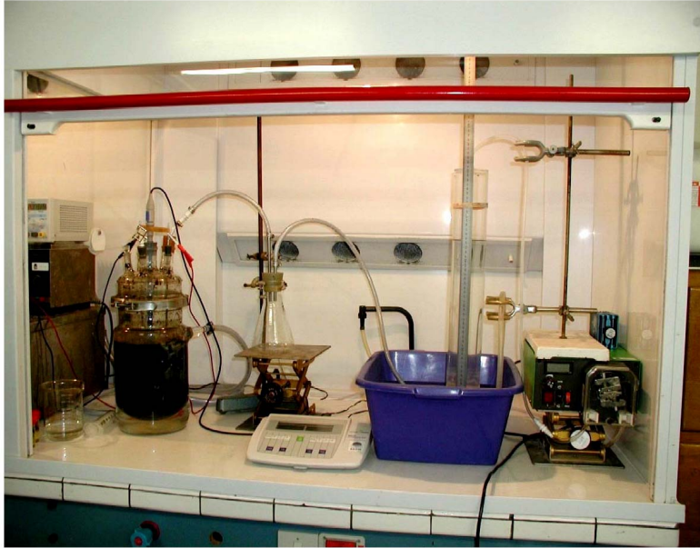
Pl. 4 - Système mis en œuvre permettant la maturation accélérée du déchet et la mesure du volume de gaz en continu.
