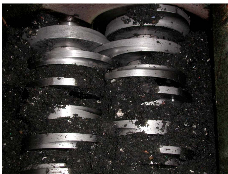
Pl. 3 - Broyage du déchet.
