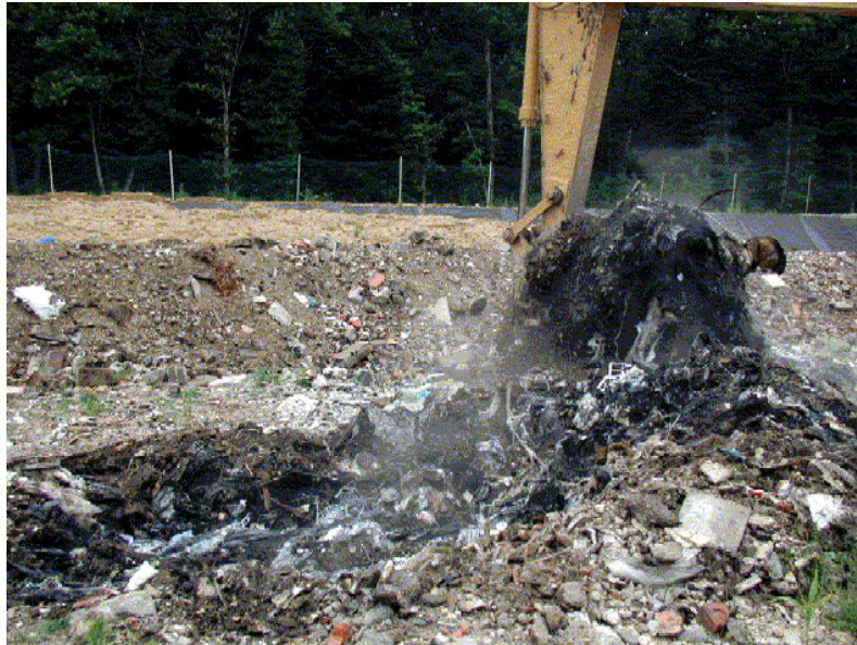
Pl. 1 - Échantillonnage de déchets à la pelle mécanique sur la décharge de Mézières-les-Cléry (Loiret).
