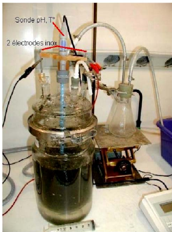
Pl. 5 - Réacteur de 5 litres équipé de deux électrodes et d'une sonde pH, T°.
