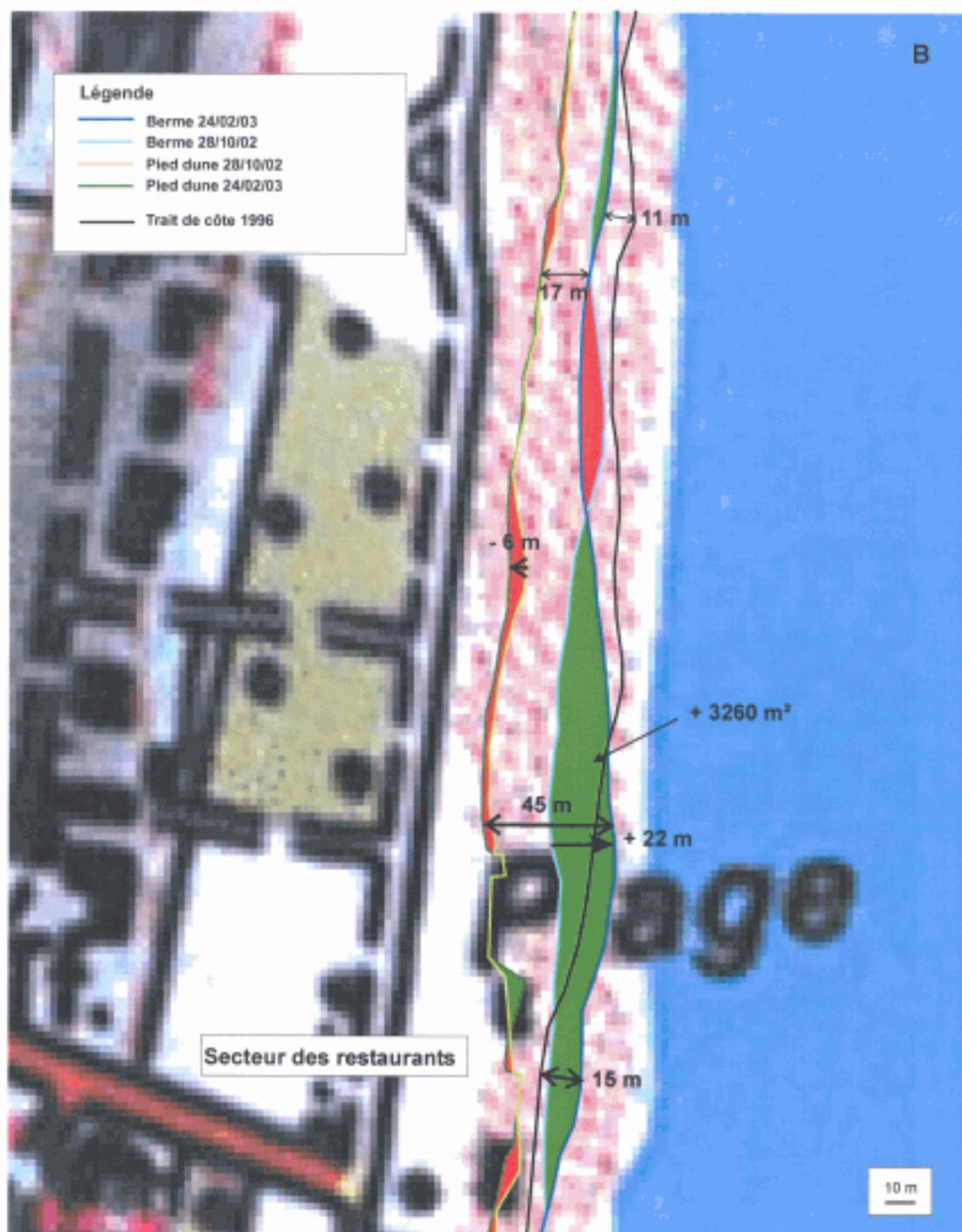
Fig. 5 – Site Tavignano, levés DGPS – 28/10/2002 et 24/02/2003 : zoom sur la zone Padulone. En rouge, les surfaces en érosion ; en vert, les surfaces en accrétion.
