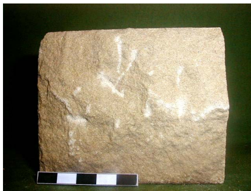
Echantillons de Pierre de Noyant et Pierre de Sainte-Maure (« Tuffeau Jaune »)
