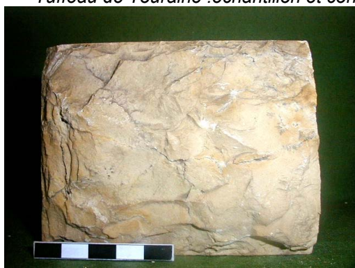
Echantillons de Pierre de Pernay et Pierre de Chédigny (« Calcaires lacustres de Touraine »)
