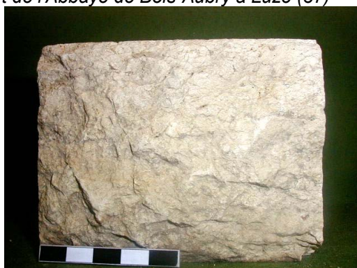
Echantillons de Pierre de Pernay et Pierre de Chédigny (« Calcaires lacustres de Touraine »)
