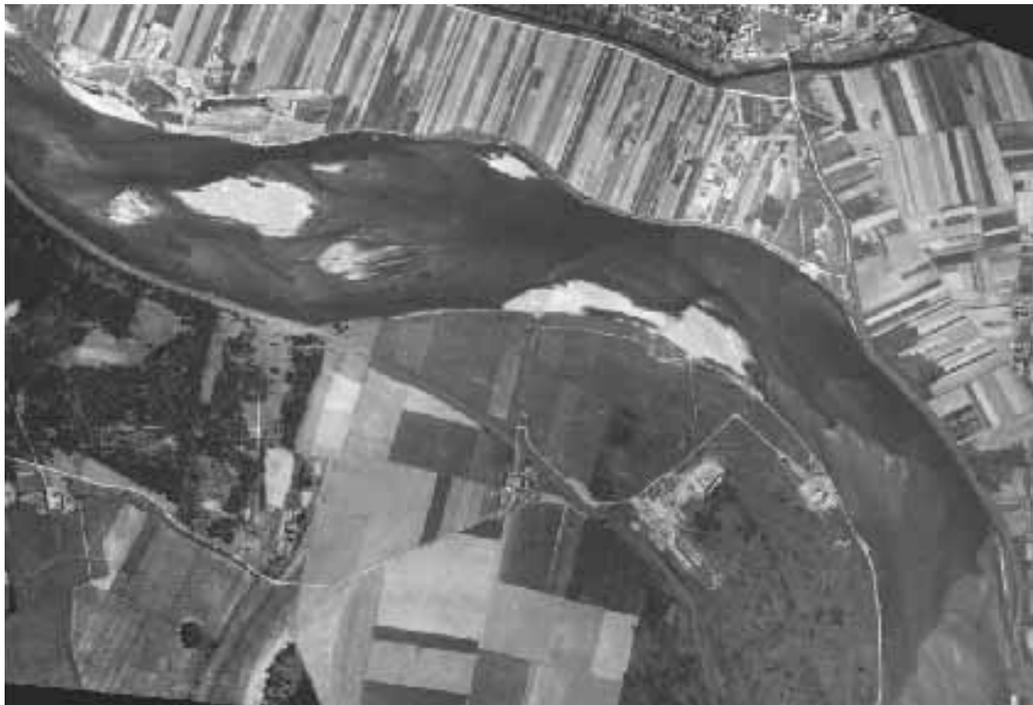
La morphologie du lit mineur montre l'alternance de mouilles, seuils et grèves, les deux derniers constituant des obstacles pour la navigation.
