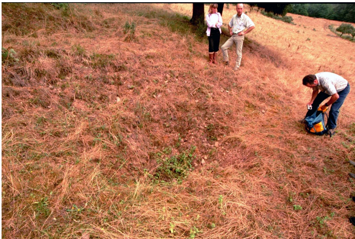
Photo 11 - Fontis remblayé sur la tête du puits n° 1 (site 11).
