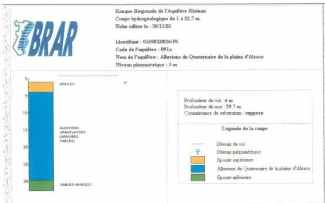
Figure 9 : Coupe hydrogéologique (profondeur du substratum)
