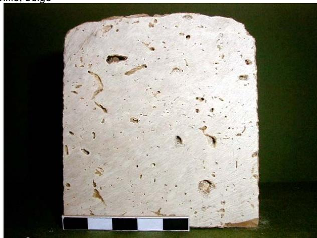
Dénomination(s) pétrographique : construction stromatolithique calcaire, biotubée, intrabréchifiée
