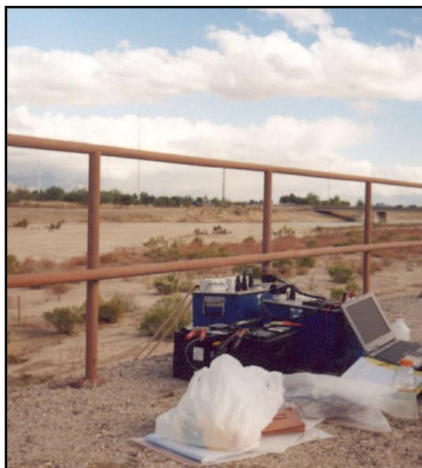
*Fig. 11 - Équipement de Résonance Magnétique Protonique « NUMIS » sur site.*
