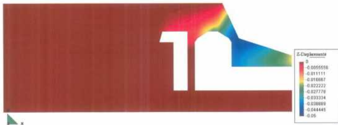
Annexe 7.6 – Déplacements horizontaux calculés (direction z) : coupe pilier nord
