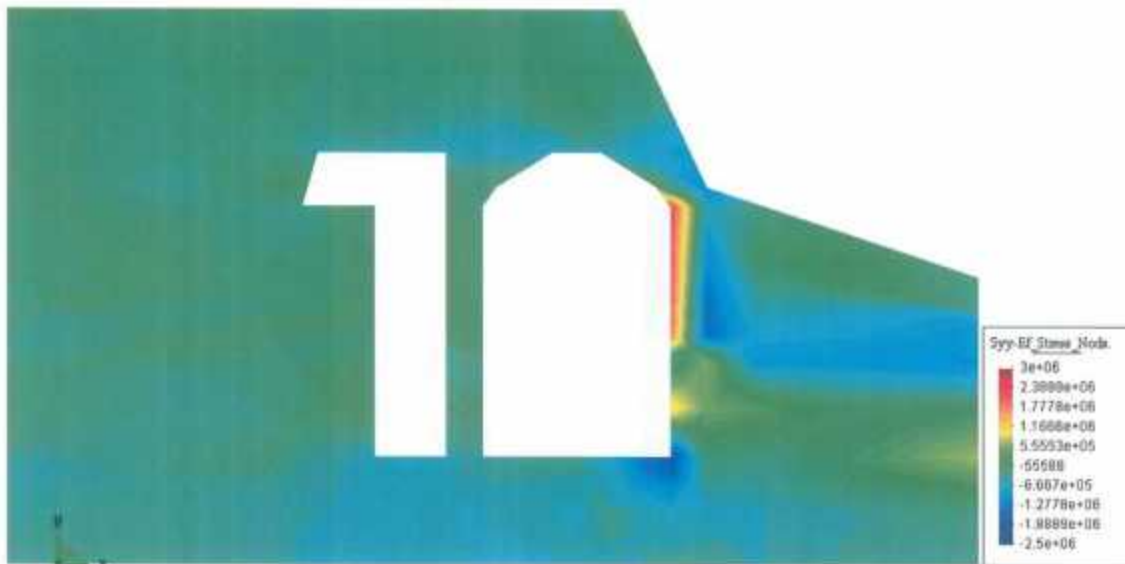
Annexe 7.11 – Contraintes verticales calculées (direction y) : coupe pilier nord
