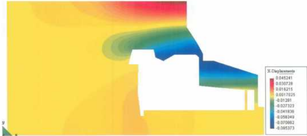
Annexe 6.11 – Déplacements horizontaux (excavation 2D, renforcement secteurs 1+2)
