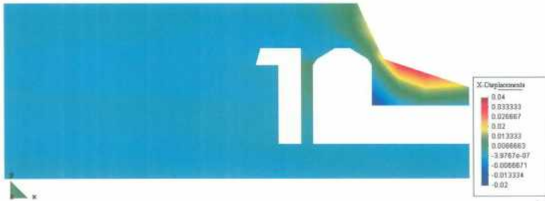
Annexe 7.5 – Déplacements horizontaux calculés (direction x) : coupe pilier nord
