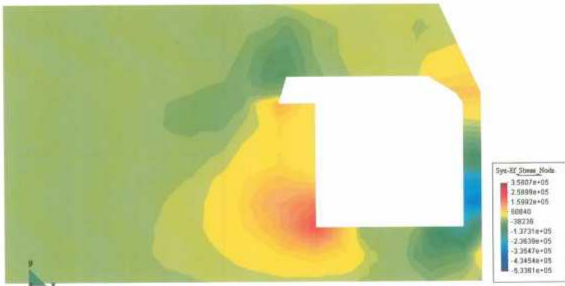
Annexe 7.42 – Contraintes de cisaillement calculées (plan yz) : coupe entrée de l'église
