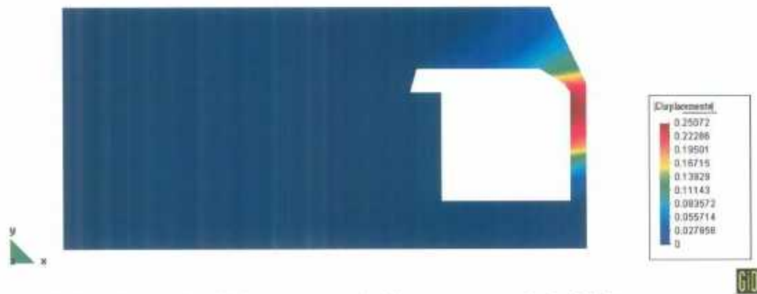
Annexe 7.38 – Norme des déplacements calculés : coupe entrée de l'église
