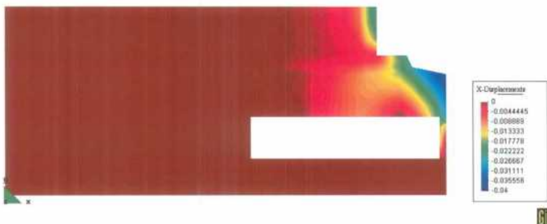
Annexe 7.25 – Déplacements horizontaux calculés (direction x) : coupe salle des sarcophages
