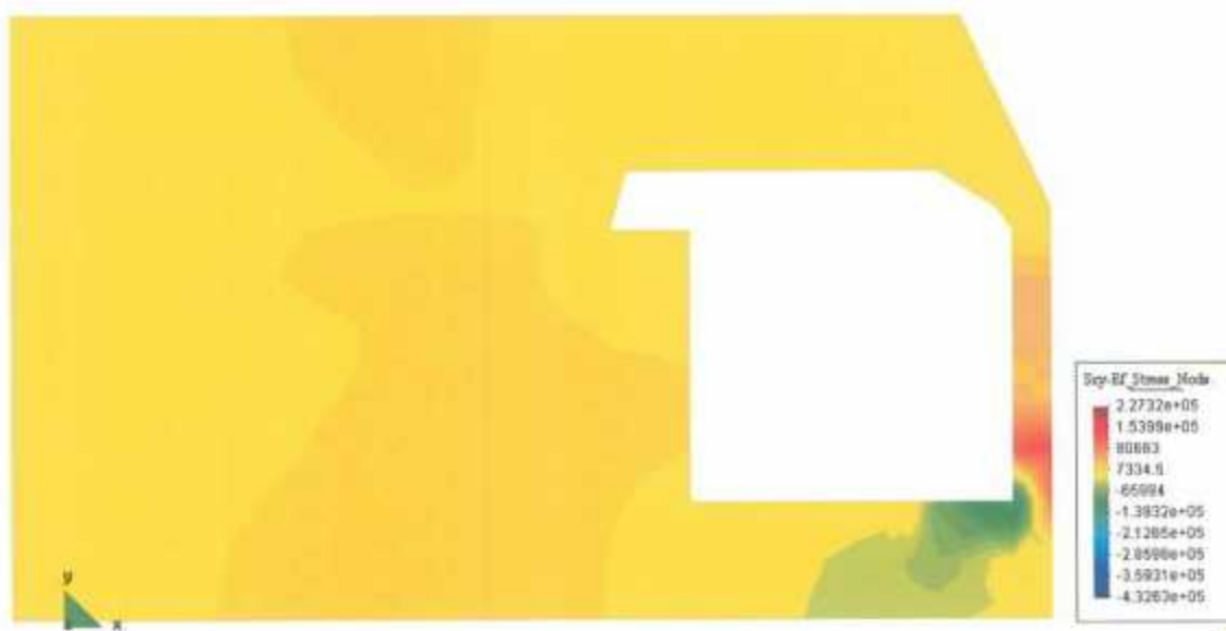
Annexe 7.44 – Contraintes de cisaillement calculées (plan xy) : coupe entrée de l'église
