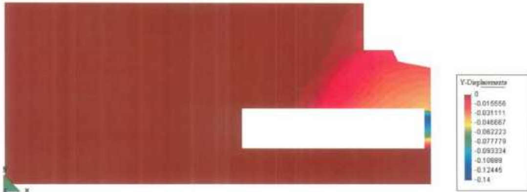
Annexe 7.27 – Déplacements verticaux calculés (direction y) : coupe salle des sarcophages
