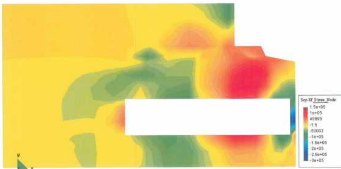
Annexe 7.34 – Contraintes de cisaillement calculées (plan xy) : coupe salle des sarcophages
