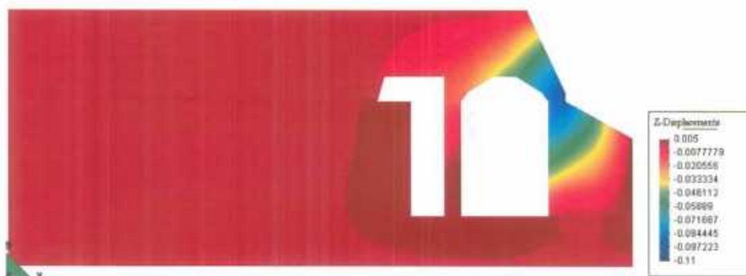
Annexe 7.16 – Déplacements horizontaux calculés (direction z) : coupe pilier sud
