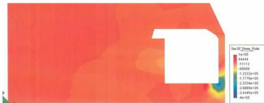
Annexe 7.43 – Contraintes de cisaillement calculées (plan xz) : coupe entrée de l'église
