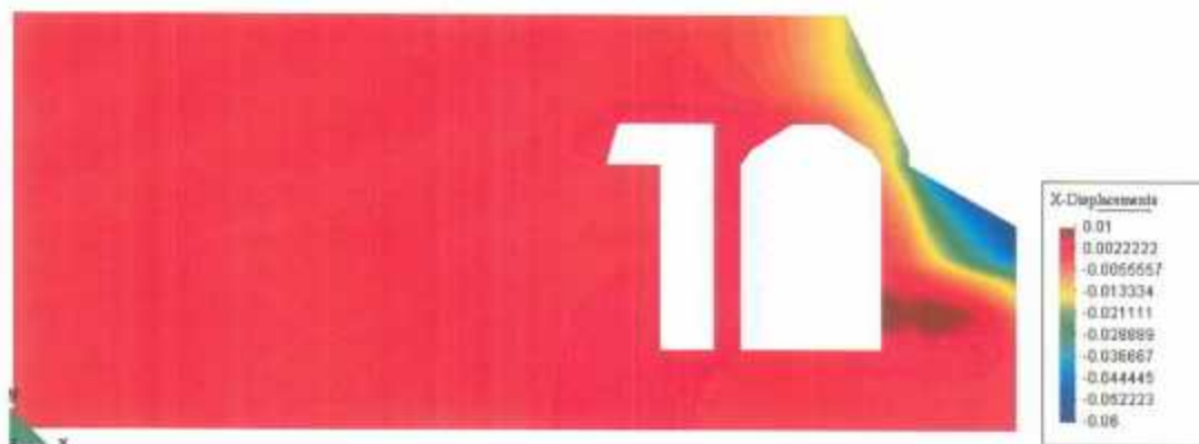
Annexe 7.15 – Déplacements horizontaux calculés (direction x) : coupe pilier sud
