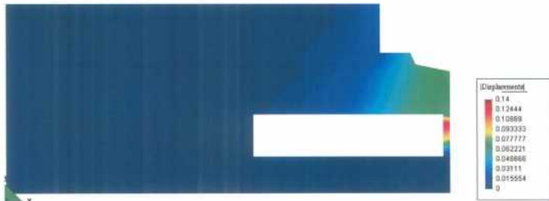
Annexe 7.28 – Norme des déplacements calculés : coupe salle des sarcophages
