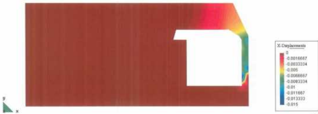
Annexe 7.35 – Déplacements horizontaux calculés (direction x) : coupe entrée de l'église
