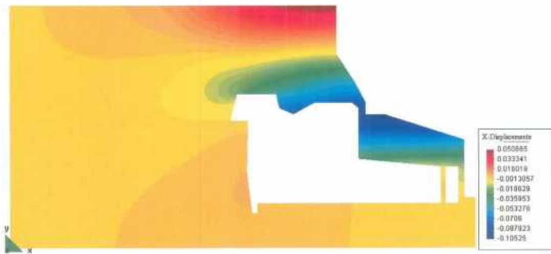
Annexe 6.8 – Déplacements horizontaux (excavation 2D, renforcement secteur 1)
