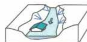
Inondation par concentration du ruissellement dans une ravine
