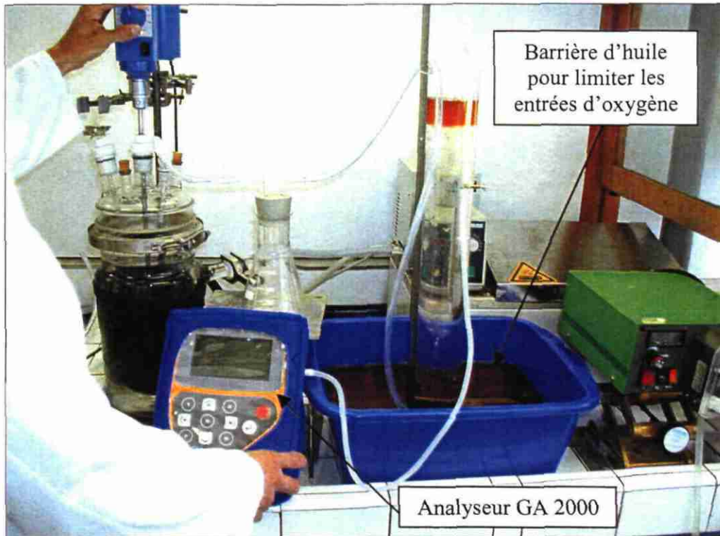
Planche 9 : Essai d'amélioration du système 1 de l'expérience « Réacteur »
