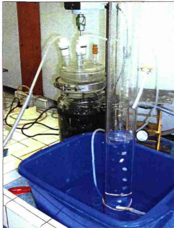
Planche 6 : Bullage du gaz dans l'éprouvette graduée
