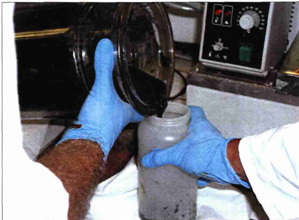
Planche 10 : Récupération de la boue issue du réacteur pour analyses
