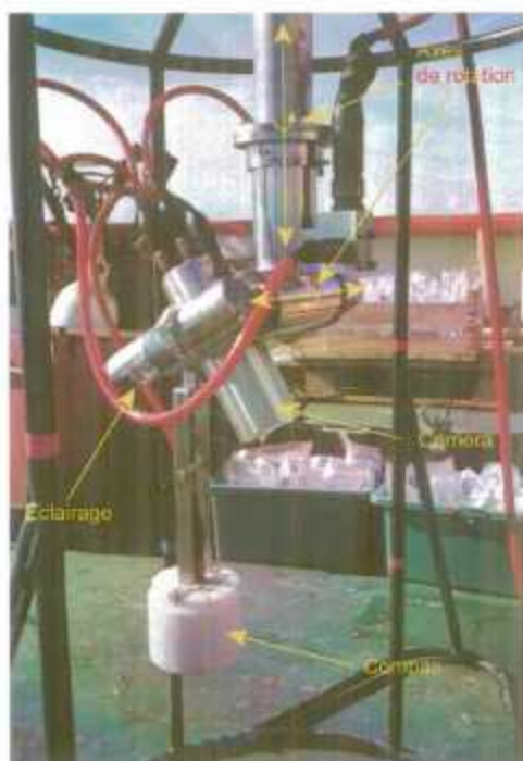
Détail de la caméra vidéo-sous-marine : axes de rotation (vertical et horizontal) et compas (boîte cylindrique blanche en bas du système).
