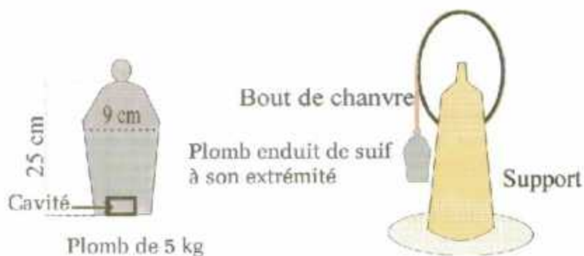
Fig. 9 - Schéma du plomb suifé (image EPSHOM, Brest).
