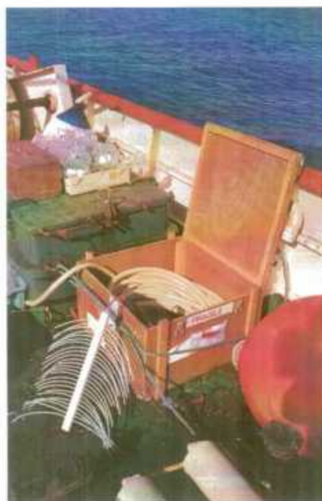
Electrodes (peigne 50 brins) de la source sparker 250 joules
