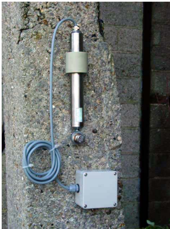
Fig. 25 – Accéléromètre situé sur le pilier droit de la terrasse dans le jardin de M. Deschamps
