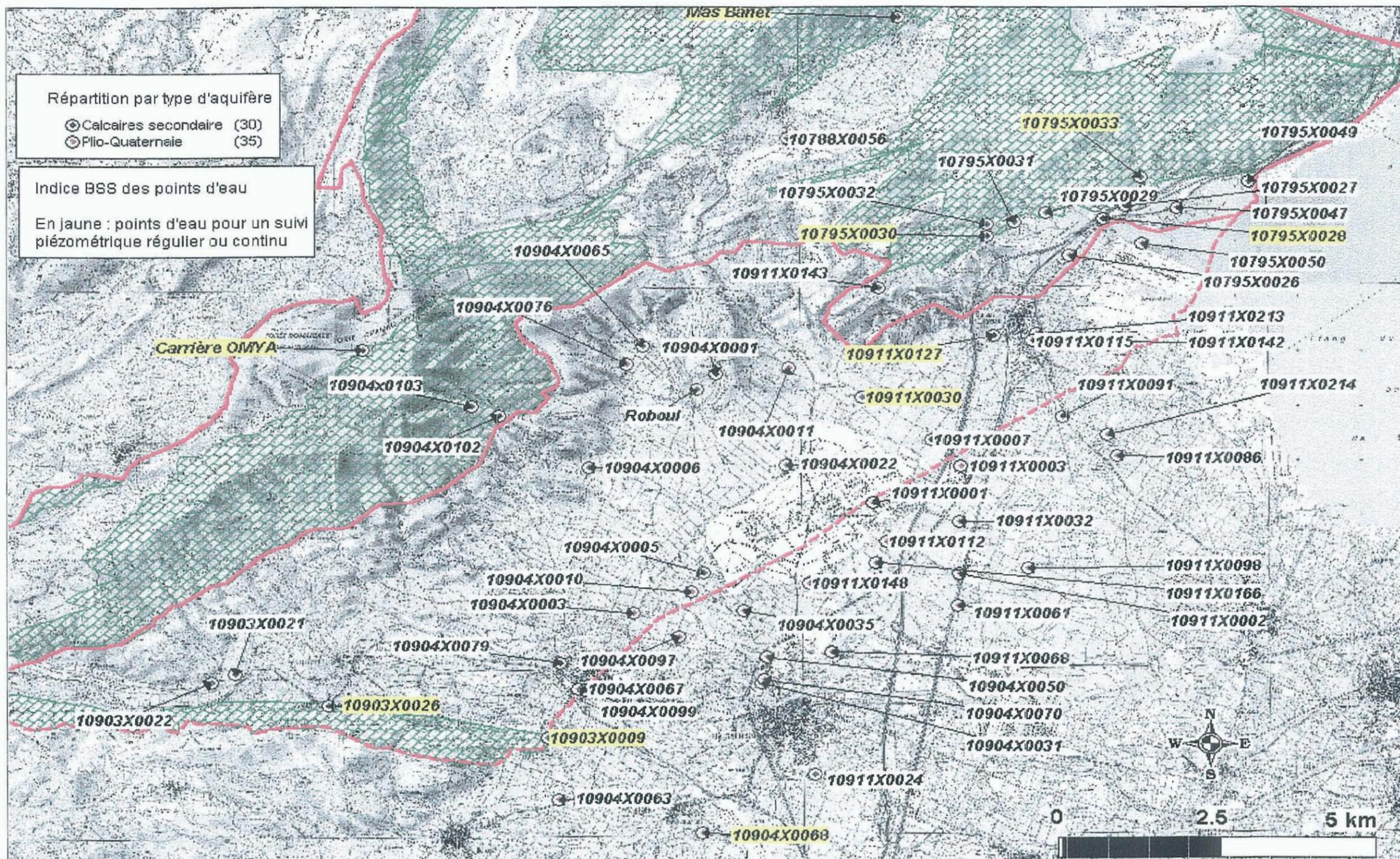
Figure 3 : Carte des points d'eau inventoriés en vue d'établir un réseau de suivi piézométrique dans les calcaires du système de Fontestramar-Fontdame et de Cases de Pène.
