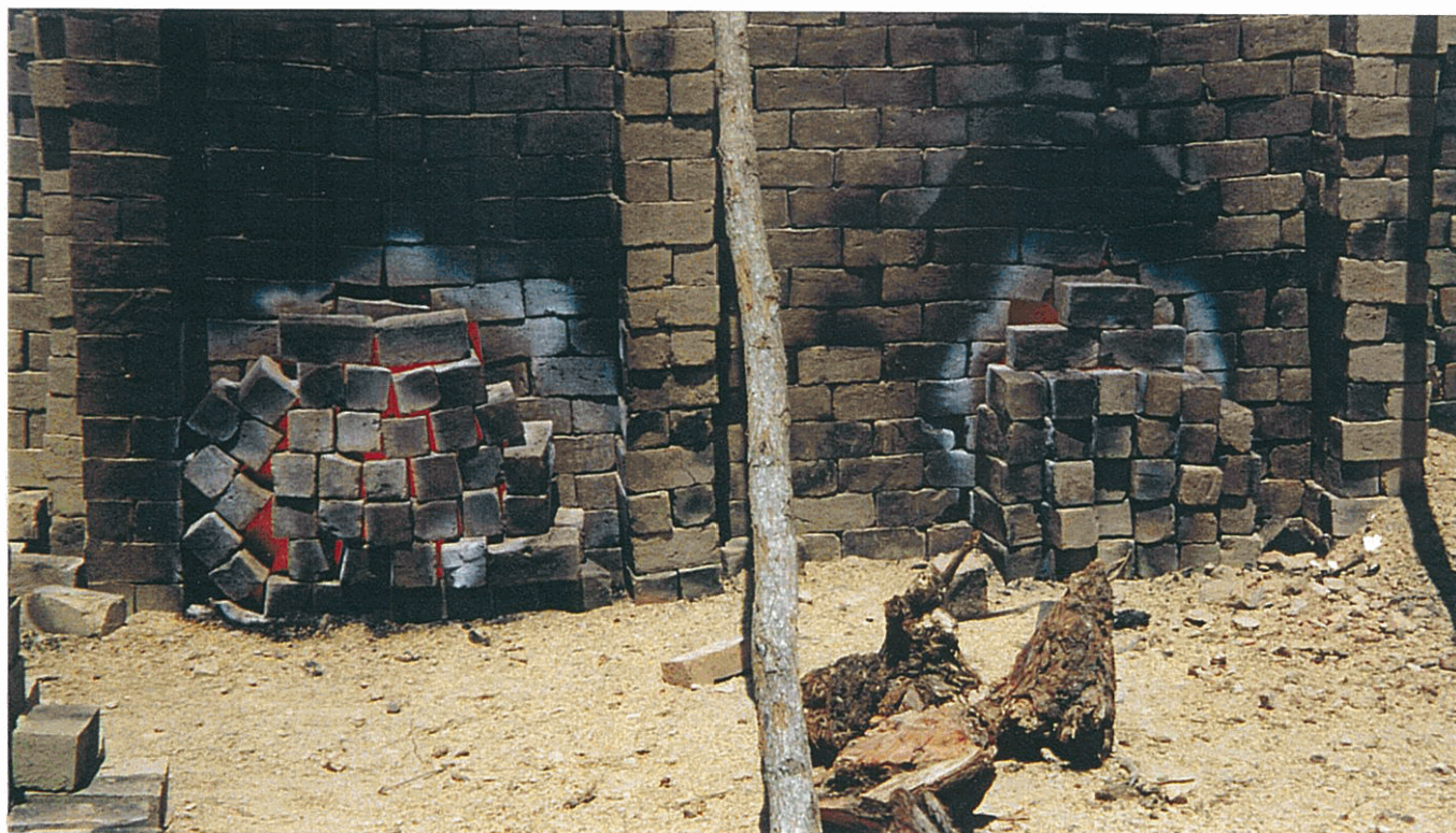
Photographie n° 9 : Mise en cuisson (feu de bois) dans un four à briques traditionnel des environs d'Antananarivo.
