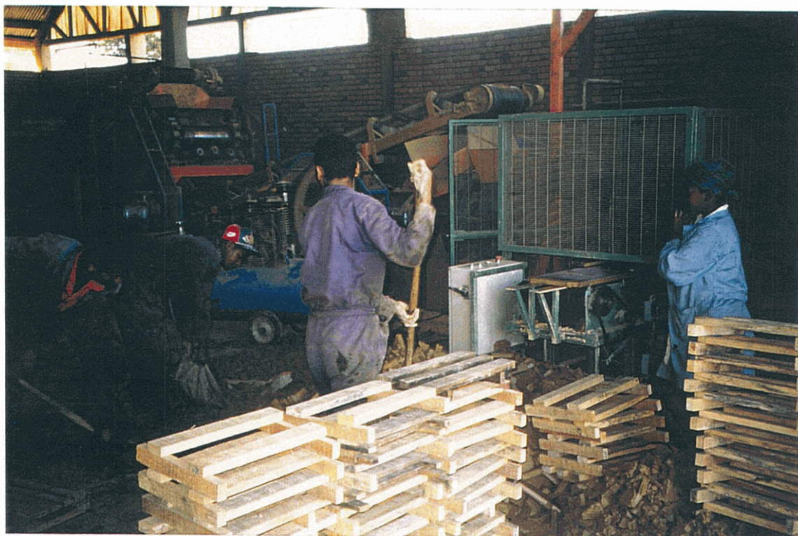
Photographie n° 16 : Briqueterie de Moramanga : filière d'extrusion des dalles de terre cuite (remarquer les pertes abondantes en matière première).
