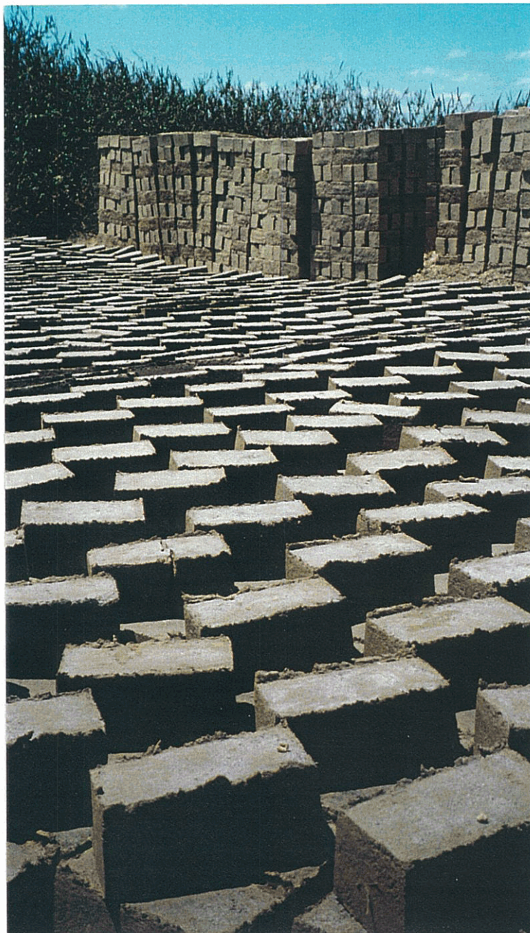
Photographie n° 10 : Séchage à l'air libre de briques fabriquées artisanalement à partir de terre argileuse - Environs d'Antananarivo.
