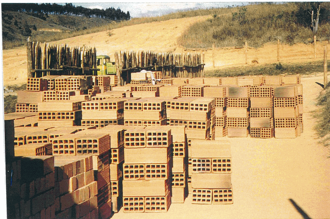
Photographie n° 14 : Briques creuses produites par la briqueterie de Moramanga, entreposées à l'extérieur de l'usine.
