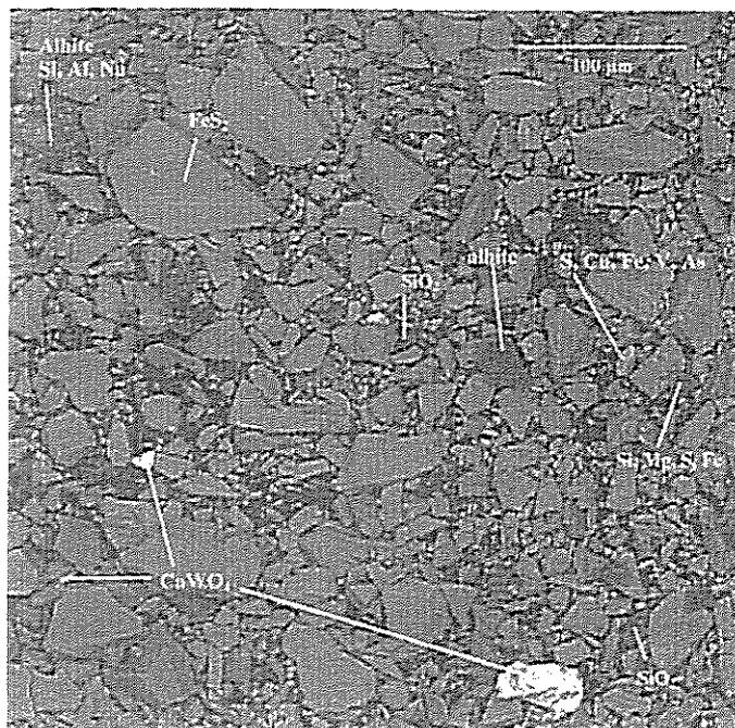
Fig. 5 - Observation au MEB du lot de pyrite n° 1.
