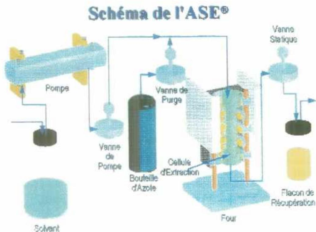
Fig. 16 - Schéma du système d'extraction par un solvant chaud sous pression (PSE).
