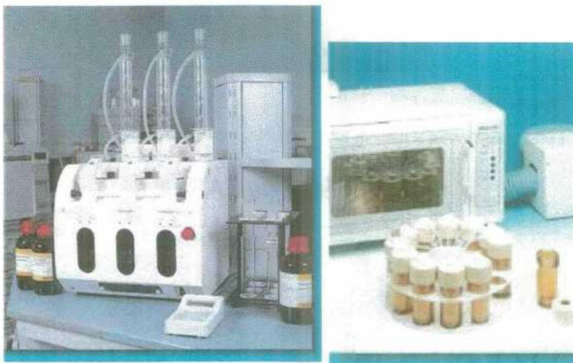
*Fig. 17 - Extraction assistée par micro-ondes en systèmes ouvert et fermé.*
