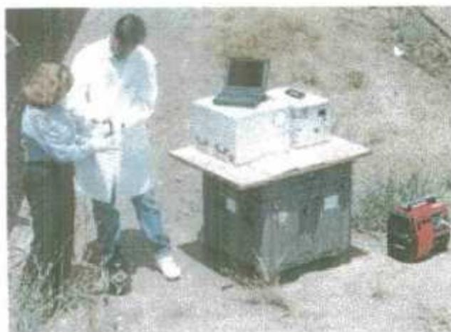
*Fig. 42 - Chromatographe couplé GC/MS sur le terrain.*
