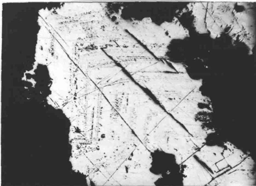
Villevieille - Minéralisation de phase B - Galène zonée (échantillon prélevé dans la zone d'oxydation, et non attaqué sur section polie). SP 1007, lum. nat., gr. 47.
