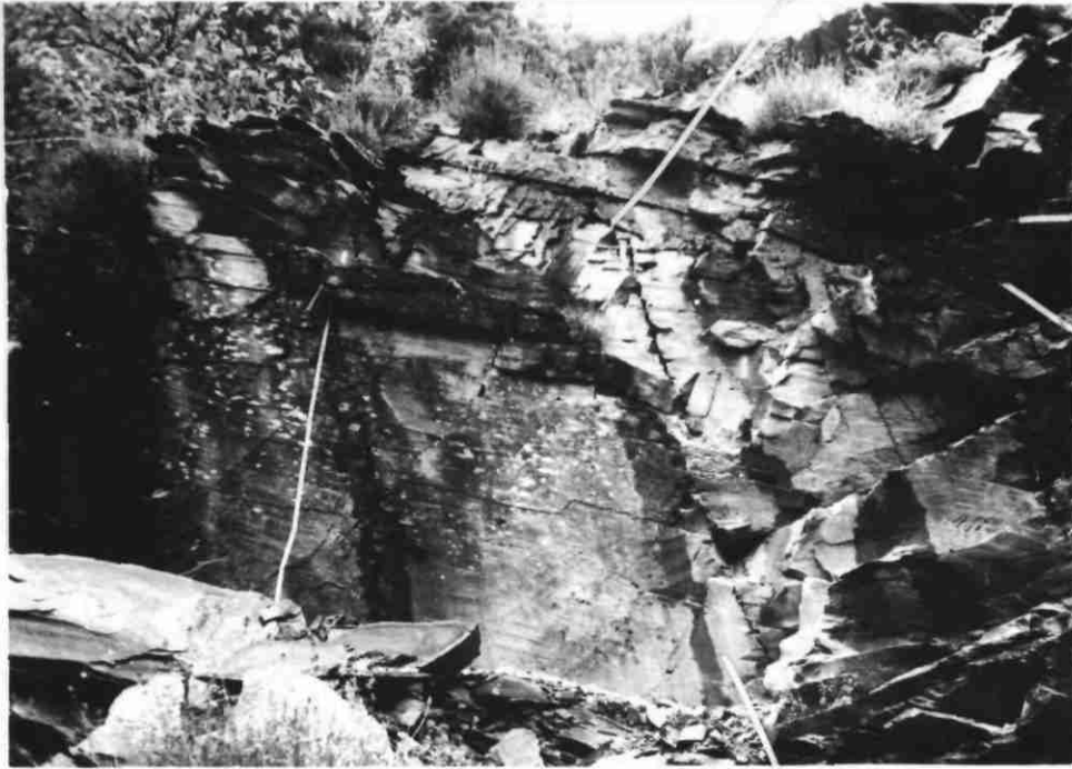
Fig. 1 - Exemple de fracturation dans le Flysch
