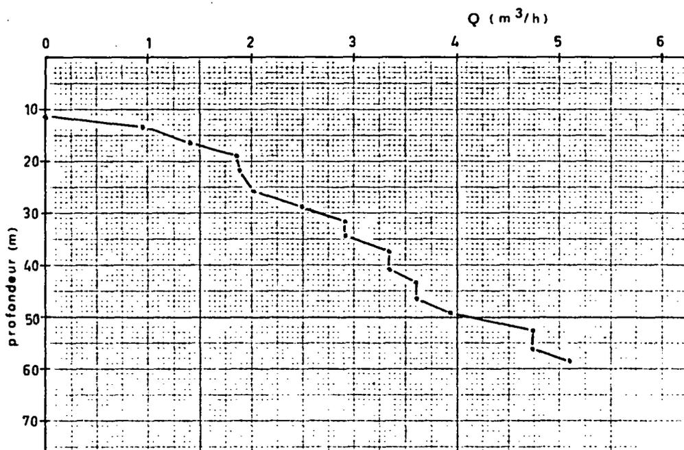
Les schistes à calymènes montrent des traces évidentes de fissuration. A S 2B le débit instantané atteint 23 m<sup>3</sup>/heure, mais on ignore si l'augmentation de débit constatée en dessous de 52 m n'est pas artificielle, due au développement des horizons supérieurs par l'effet du réalésage. Dans le doute (qui pourrait être levé par des mesures au micromoulinet), on considèrera que l'essentiel des venues d'eau est localisé au-dessus de - 20 m.
