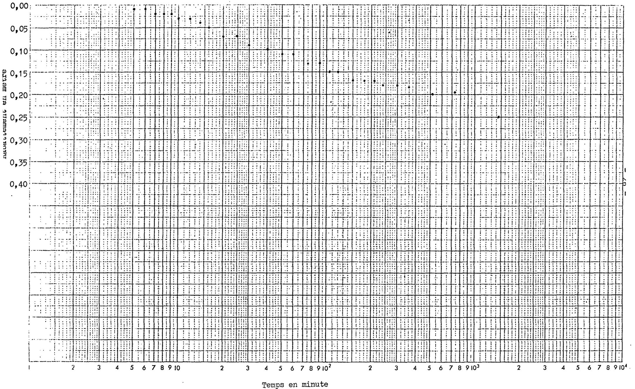
35140 SAINT GEORGES DU CHESNE - Piézomètre 4 A - Pompage dans ForEssai 4 - du 31.5 au 1.6.1978 - Q moyen 10 m<sup>3</sup>/h - distance 84,00 m.
