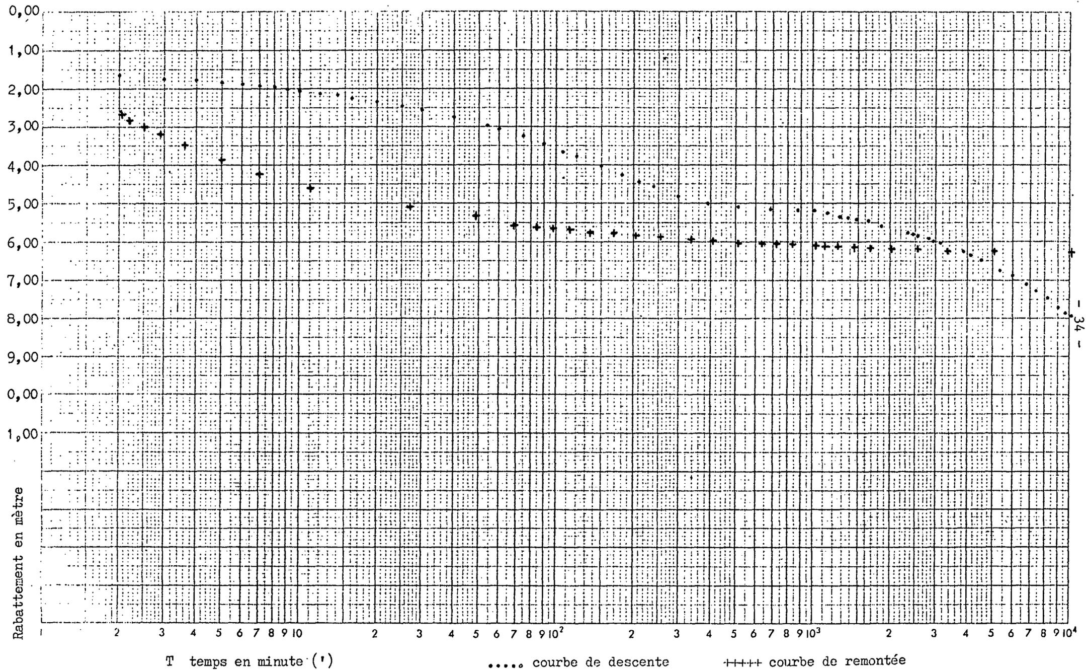
35140 SAINT GEORGES DE CHESNE - Piézomètre 4C - Essai dans ForEssai 4 - du 15 au 20 juin 1978 - Q moyen 10,37 m<sup>3</sup>/h - distance 97 m.
