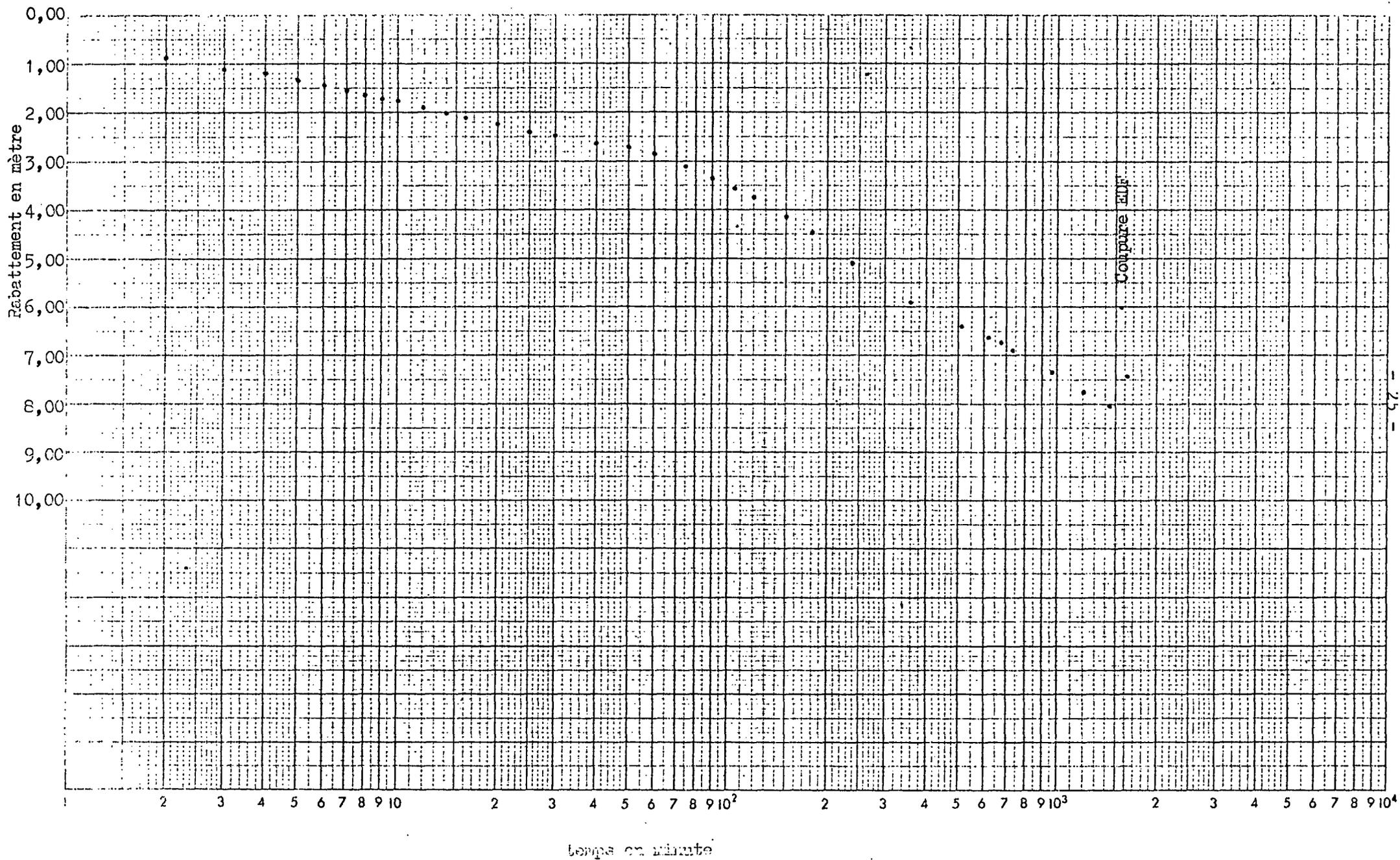
35140 SAINT GEORGES DU CHESNE - Piézomètre 4 C - Pompage dans ForEssai 4 - du 31.5 au 1.6.1978 - Q moyen 10 m<sup>3</sup>/h - distance 78 mètres.
