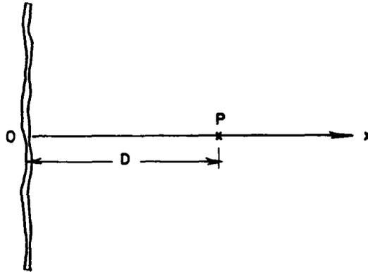
Pour faire ce calcul, on utilise la théorie des images et la théorie des potentiels complexes. Le potentiel en tout point de l'aquifère est identique au potentiel qui serait engendré par un doublet formé d'un puits de pompage  $P$  de débit  $Q$  à une distance  $D$  de la limite, associé à un puits d'injection  $I$  de débit  $Q$  situé symétriquement par rapport à la limite.
