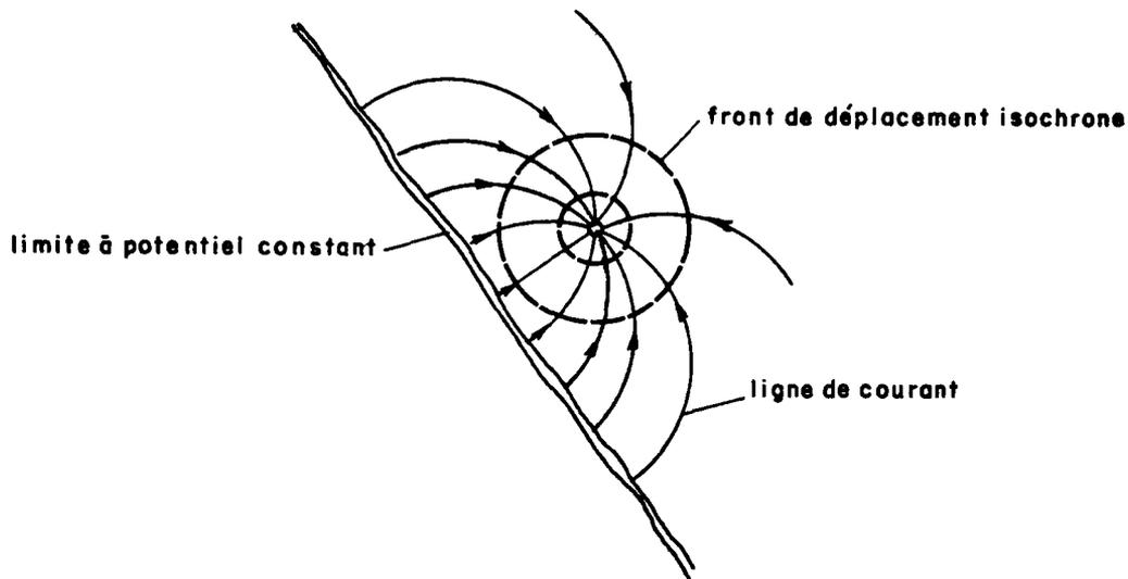
Les fronts de déplacement sont des courbes ressemblant un peu à des cercles ; le calcul de leurs équations est développé dans l'annexe II. L'utilisateur peut facilement déterminer la position des fronts sans effectuer de calculs compliqués en se servant de l'abaque de l'annexe I.
