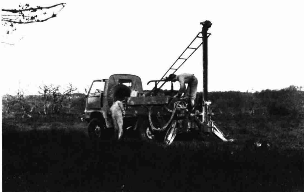
Photo 3 : Vue d'ensemble de la sondeuse D 9000 montée sur camion 4 x 4 permettant la réalisation des sondages dans les zones non marécageuses du gisement
