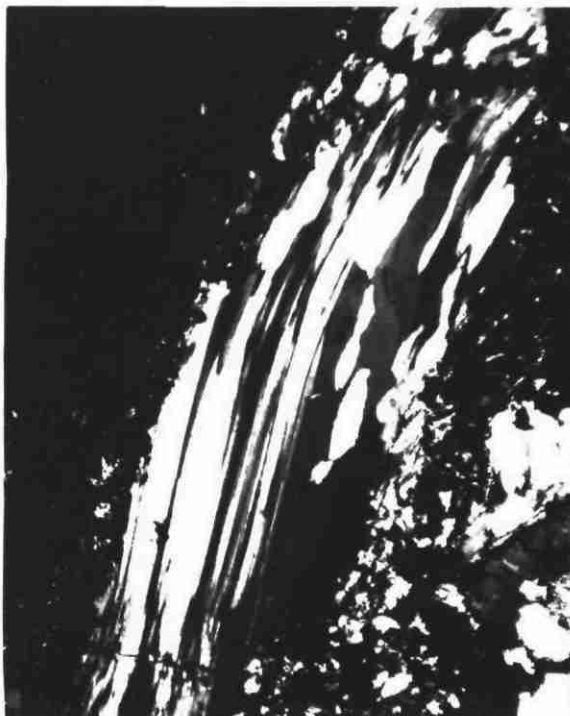
P.13/ Quartz étiré dans le micaschiste graphiteux (éch. 7044; recoupe 2 nord - 13,30 m). LM x40; nicols croisés.
