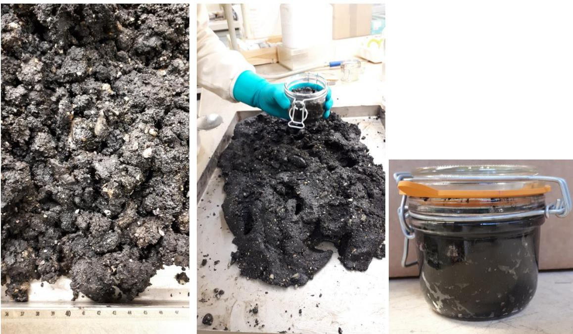
Figure 1 : Photographies de l'échantillon brut lors du malaxage (à gauche), au début de la mise en flacon à la spatule (au milieu), d'un flacon rempli sans espace de tête (à droite)
