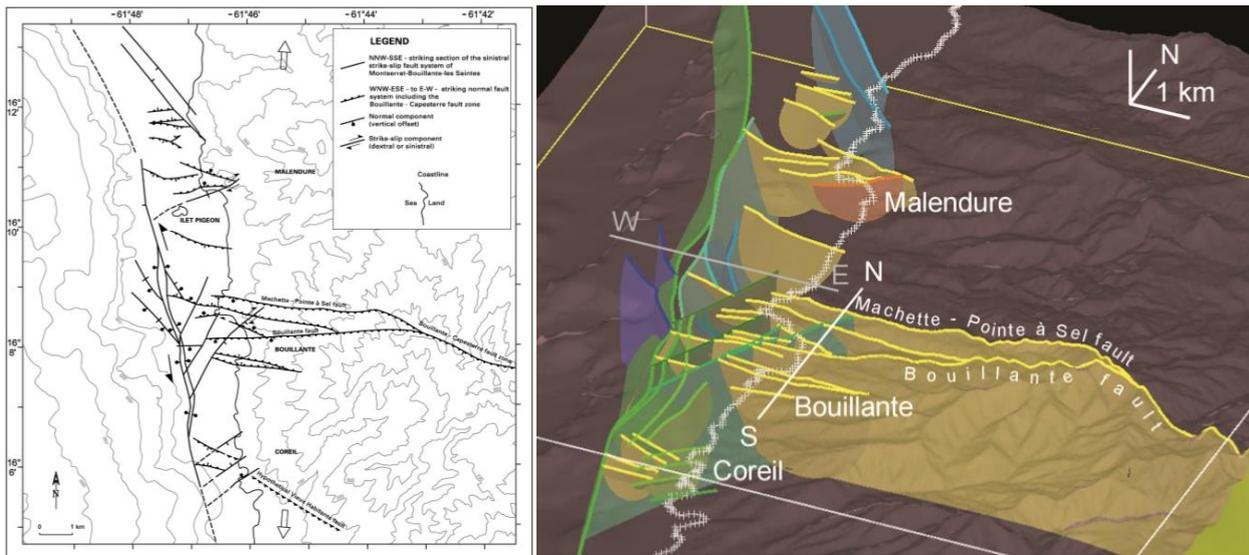
Figure 14 - Modèle géologique 3D du champ géothermique de Bouillante, réalisé avec le logiciel Geomodeller (Calcagno *et al.*, 2013) et les données provenant principalement de Thion *et al.* (2009) et Bouchot *et al.* (2013).
