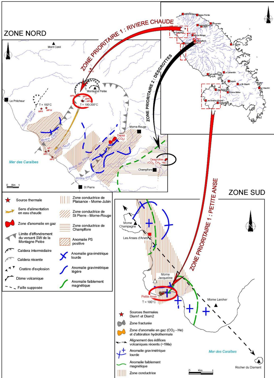
Figure 35 - Schéma de synthèse des travaux du BRGM de 2003 représentant les zones prioritaires pour l'implantation de forages d'exploration géothermique de haute température en Martinique (Sanjuan et al., 2003b).
