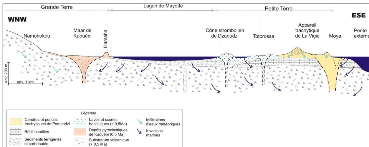
Figure 89 - Section verticale interprétative entre Mamoudzou et Petite Terre selon un profil orienté ONO-ESE, montrant la géologie et les écoulements de fluides supposés dans le substratum (échelle verticale triplée par rapport à l'échelle horizontale pour mieux visualiser les reliefs) (Traineau et al., 2006).
