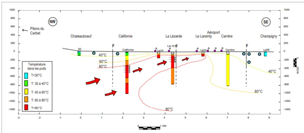
Figure 28 - Carte de synthèse montrant la localisation des forages d'exploration géothermique réalisés dans la plaine du Lamentin, avec les isothermes 40 et 80 °C à 100 m de profondeur, tracés à partir des mesures de forage, et coupe nord-ouest/sud-est interprétative proposée pour ce système géothermique de basse température, à partir des données de terrain et de forages (Traineau, 2001 ; Sanjuan et al., 2002).
