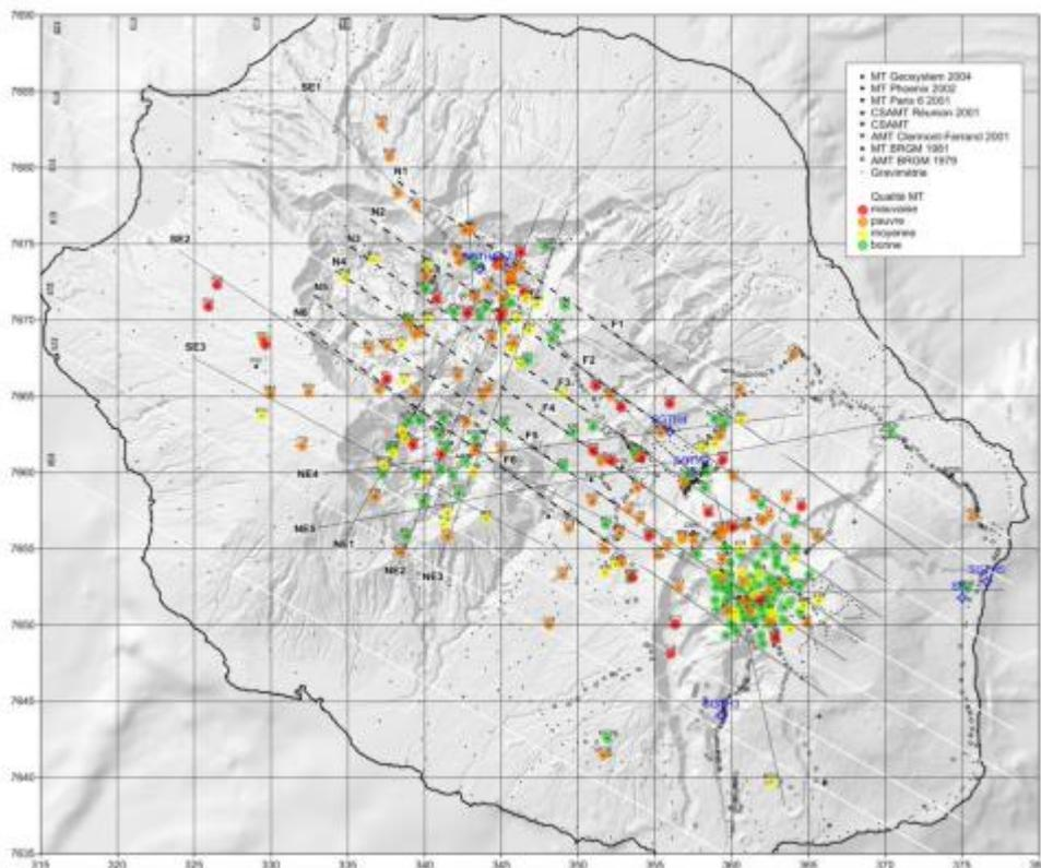
Figure 63 - Carte illustrant la qualité des sondages (A)MT. Les profils MT des différents rapports PB Power sont représentés par des traits noirs, les profils gravimétriques du rapport Lénat et al. (2003a) par des traits blancs (Dezayes et al., 2015).
