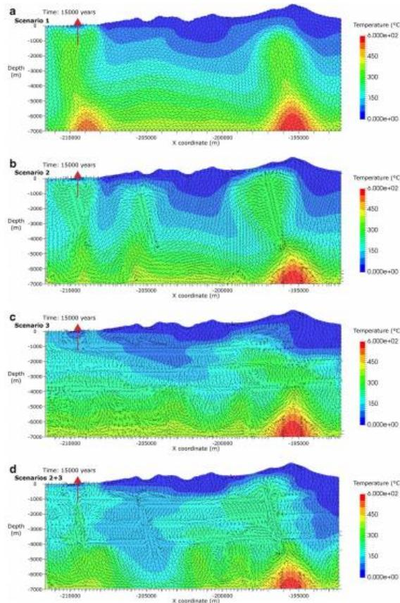
Figure 23 - Résultats de simulations thermiques faites sur une coupe Soufrière - Bouillante (voir fig. 21), après 15 000 ans. a) Avec une seconde source de chaleur magmatique sous Bouillante ; b) Conduits verticaux fortement perméables ; c) Couches horizontales fortement perméables ; d) Conduits verticaux et couches horizontales fortement perméables (Raguanel et al., 2019).
