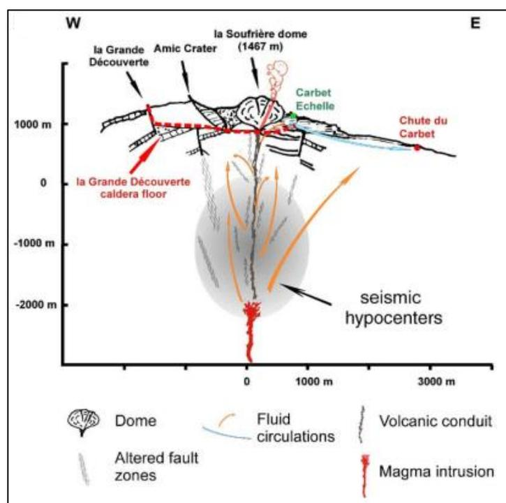
Figure 19 - Coupe schématique est-ouest montrant le fonctionnement probable des systèmes hydrothermaux profond et superficiel associés à La Soufrière et la forte compartimentation des zones de circulation dans l'édifice (Villemant et al., 2005).
