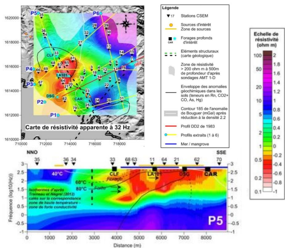
Figure 30 - Carte de résistivité apparente à la fréquence 32 Hz et pseudo-section nord-nord-ouest/sud-sud-est de résistivité apparente CSEM pour le profil P5 de la plaine du Lamentin (Gadalia et al., 2014).
