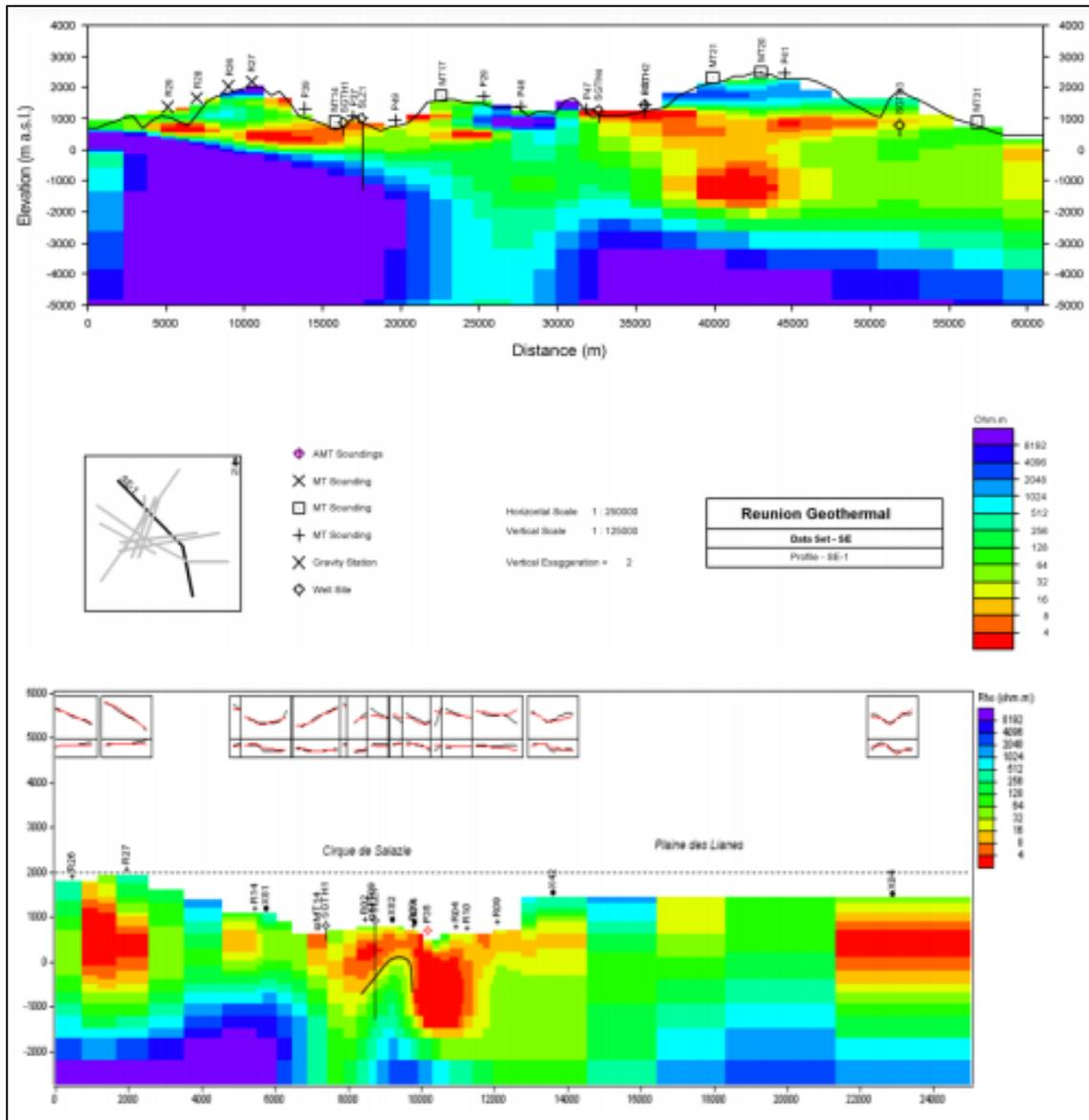
Figure 68 - Coupes de résistivité de PB Power 2002 et 2003 issues de l'inversion 2D des données MT (incluant les sondages Phoenix pour 2003) traversant le cirque de Salazie du nord-ouest au sud-est, à proximité du forage profond d'exploration géothermique SLZ-1. Une morphologie typique à celle d'un modèle de réservoir géothermique est soulignée par un trait noir dans la vue du bas (Dezayes et al., 2015).
