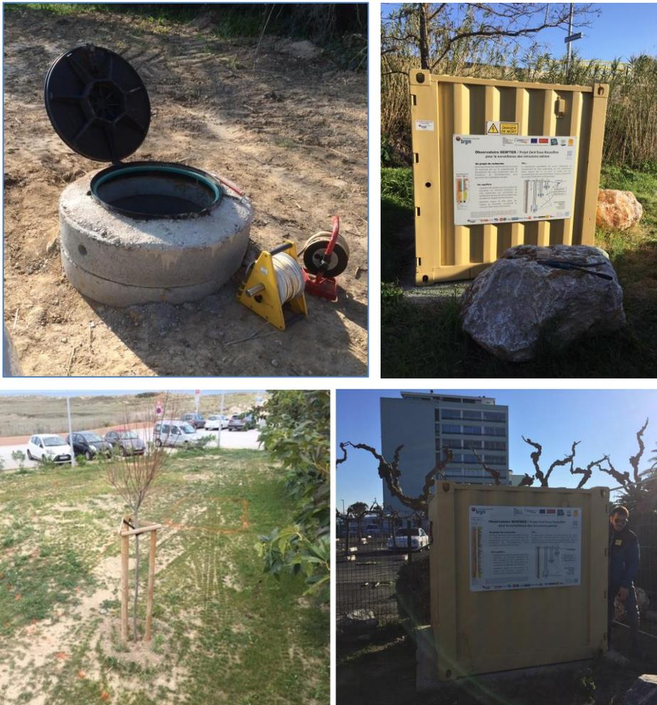
*Illustration 10: Margelle de protection hors sol des ouvrages du site de Pollestres et conteneurs de recueil du matériel de mesure et de transmission de données sur Pollestres (haut) et Canet-en-Roussillon (bas) et site de Canet (bas, gauche).*
