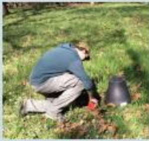
Pose de l'appareil (Tromino®) au sol pour l'enregistrement du bruit sismique ambiant pendant 20 minutes.
