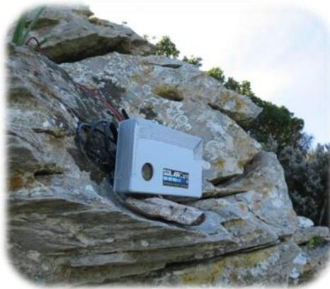
Illustration 7 – Exemple du dispositif Solarcam ([www.solarcam.fr](http://www.solarcam.fr))
