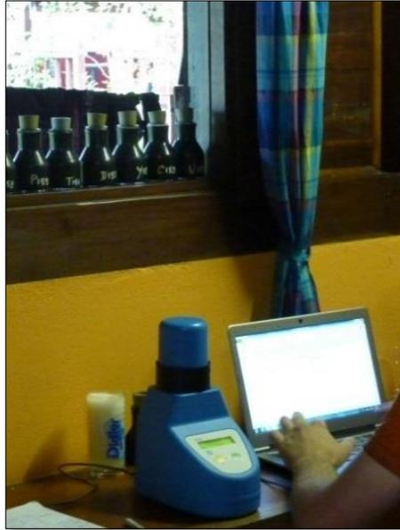
Figure 13 : Analyse de l'activité radon avec le compteur Calen (Photo BRGM 2017)
