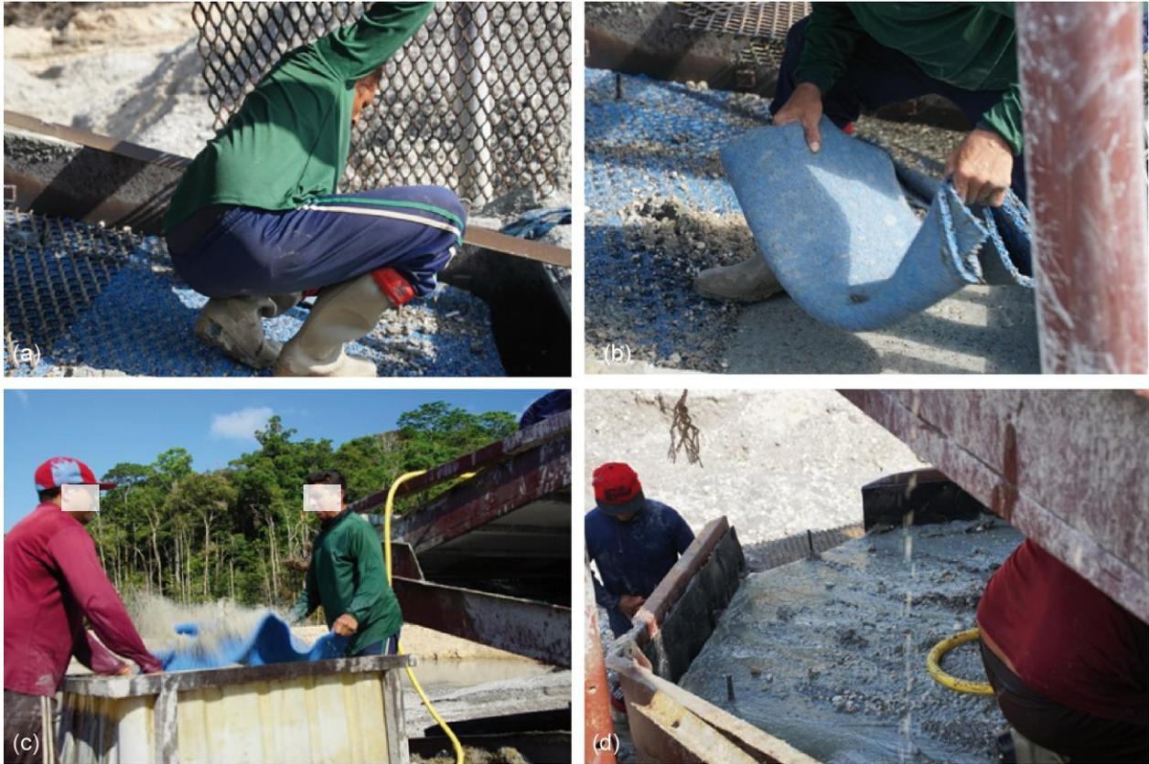
*Figure 33 : photographies des différentes étapes de la phase de levée (a) retrait des panneaux de fer déployé. (b) retrait des moquettes. (c) nettoyage des moquettes dans un bac de transport. (d) : récupération des lourds du sluice déséquipé.*
