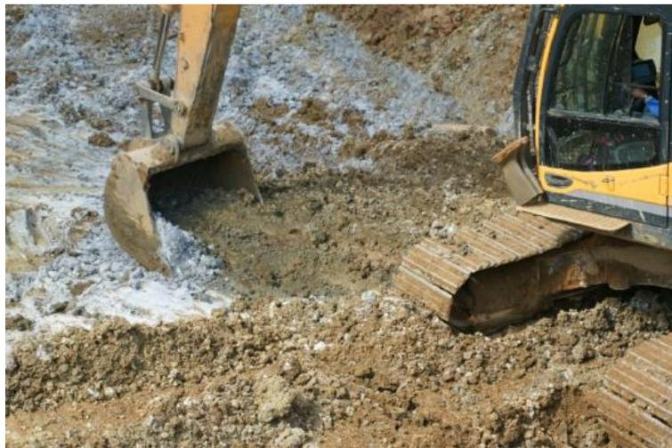
Figure 13 : Contact du gravier minéralisé avec le toit du bed-rock kaolinique blanchâtre (J.L.Nagel).
