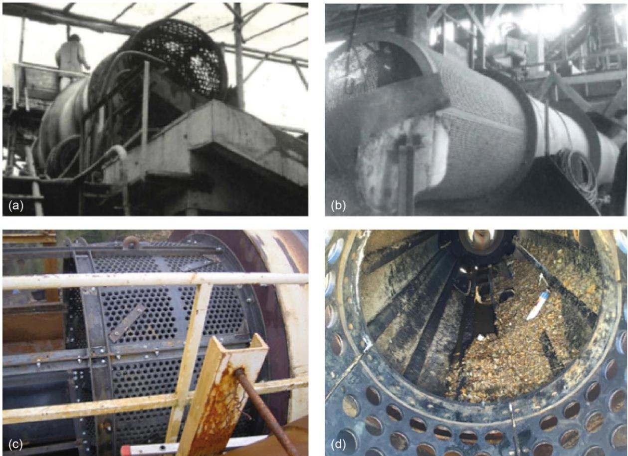
Figure 29 : Photographies de trommels utilisés dans l'exploitation aurifère. (a et b) Trommel dans une unité de lavage d'éluvions en Guyane (J. Petot, 1993). (b et c) : Trommel et son crible, ici habillés de caoutchouc (Source : <http://somatrap.fr/>).
