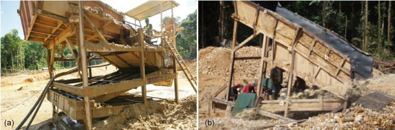
Figure 17 : modèles de laverie classiquement rencontrés dans les exploitations d'or alluvionnaire en Guyane française. (a) modèle relativement élaboré avec un poste de lance Monitor fixé à la laverie. A noter que des améliorations de ce modèle sont souhaitables. (b) Modèle rudimentaire avec un poste de lance Monitor non fixé à la laverie. Ce modèle est à proscrire, car il engendre des pertes importantes de minerai.
