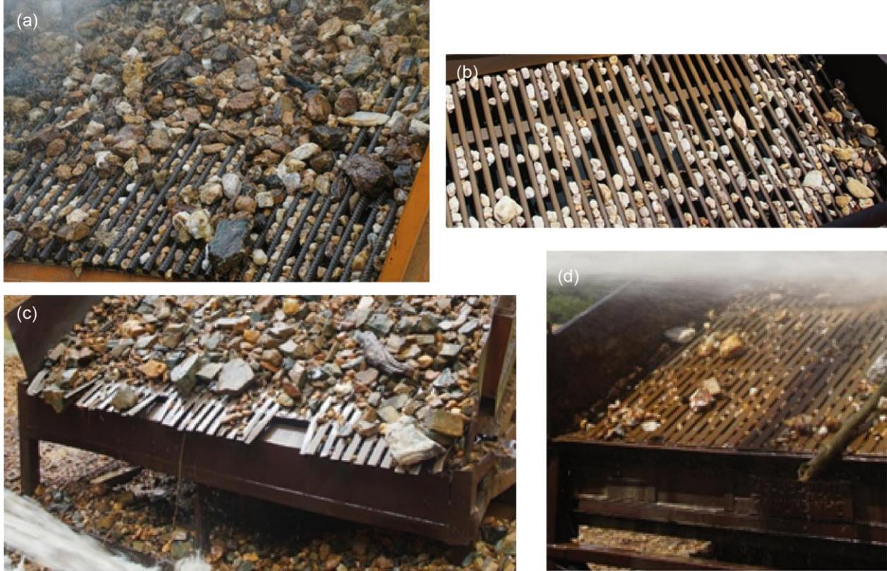
*Figure 27 : photographie des deux types de crible utilisés dans l'exploitation de l'or alluvionnaire en Guyane française. Ces photographies montrent très nettement l'engorgement du crible, en particulier pour le crible à barres rondes. A noter aussi la déformation des barres plates (c).*
