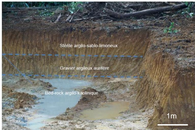
Figure 10 :Coupe d'un autre flat minéralisé sur base kaolinique (J.L.Nagel).
