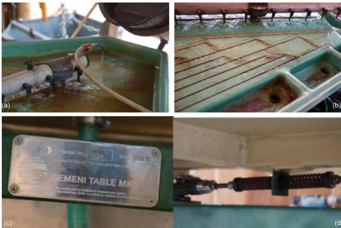
Figure 40 : photographie de détail des différents éléments d'une table à secousses Gemini. (a) réglage des flux d'eau de la table à secousses Gemini. (b) la table à secousses Gemini en production. (c) identification et réglage des secousses de la table Gemini (J.L.Nagel)
