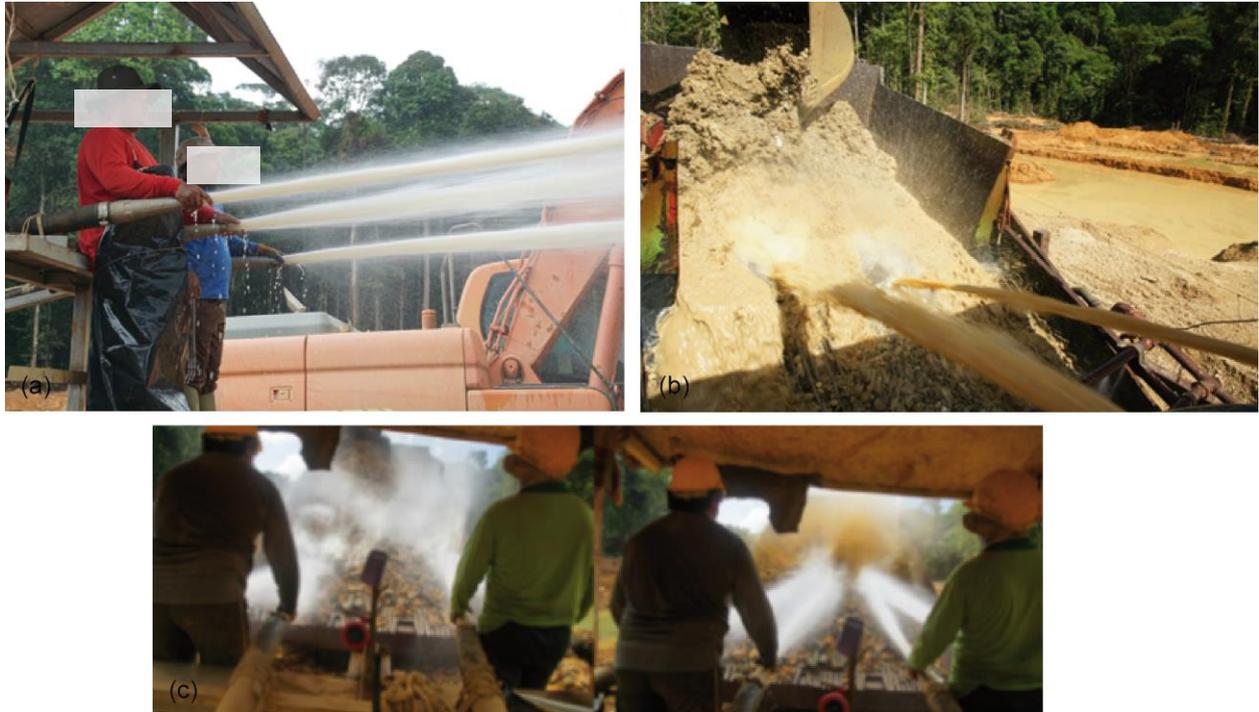
Figure 16 : photographies montrant le débouage du minerai aurifère à l'aide des lances Monitor à haute pression (J.L. Nagel). (a) lances Monitor avec 2 opérateurs, (b) gravier minéralisé en cours de liquéfaction dans la caisse de débouage, (c) vue d'ensemble du poste de lances Monitor.
