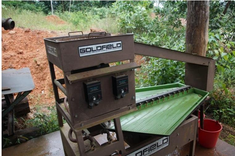
Figure 41 : photographie d'une table à secousses Goldfield (J.L. Nagel)
