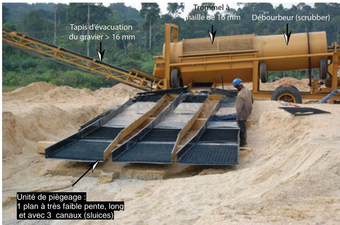
Figure 51 : exemple d'unité de traitement d'un minerai à or et diamants utilisée dans une mine d'Amérique du Sud (source : <http://www.alluvialgoldmachine.com>, modifié)
