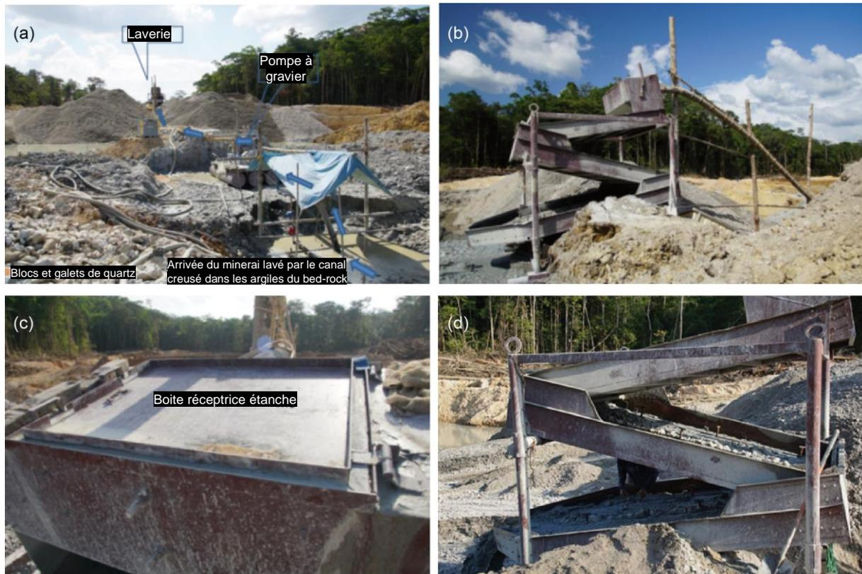
Figure 24 : photographies de l'unité de lavage avec une pompe à graviers. (a) parcours de la pulpe du chenal argileux vers la laverie. (b) la laverie, alimentation et concentrateurs. (c) la caisse étanche de réception de la pulpe. (d) les trois étages de la laverie avec pentes réglables (J.L. Nagel).
