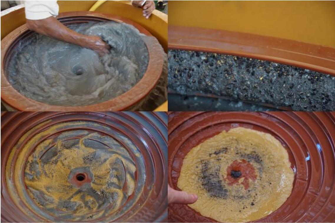
Figure 38 : Bol de Knelson, mise en œuvre et produit de sortie semi-affiné (J.L.Nagel)
