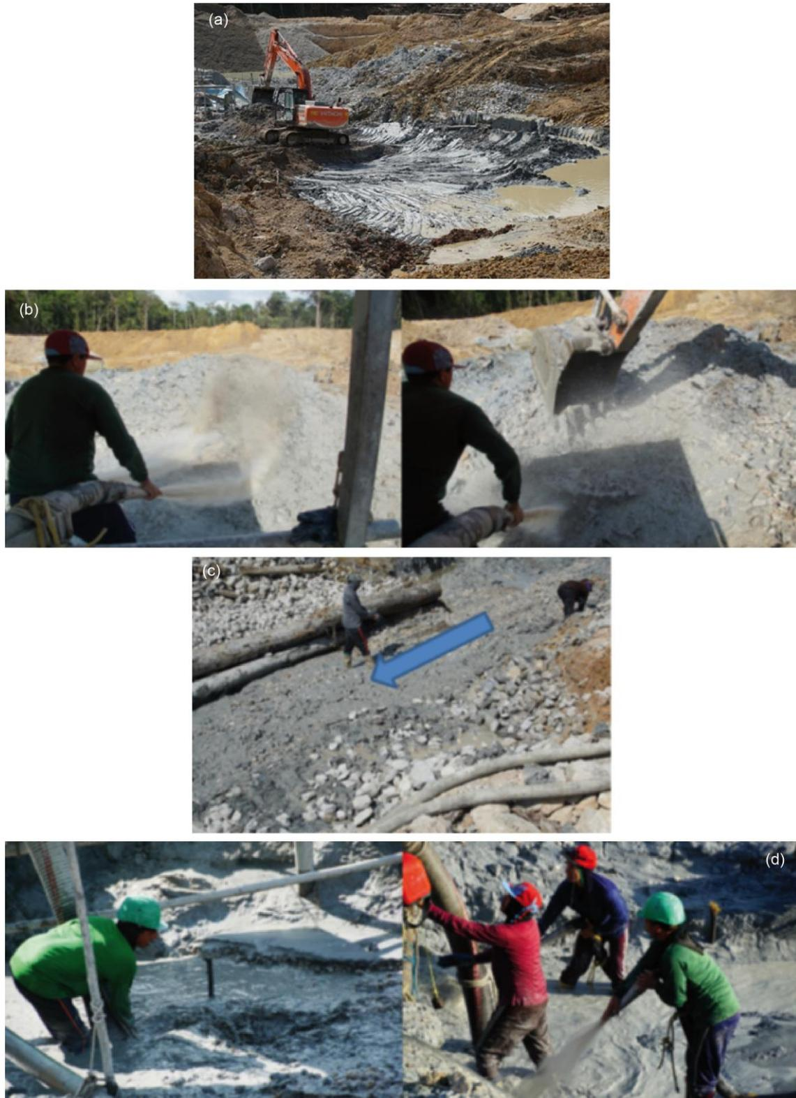
Figure 23 : photographie des différentes étapes de fonctionnement d'un système de débouage associé à une pompe à graviers. (a) façonnage du canal collecteur des graviers lavés dans le bed-rock argileux. (b) débouage du minéral par jets Monitor et brassage du tas. (c) la pulpe minéralisée s'écoule vers la pompe à graviers, et l'élimination des galets est manuelle. (d) cuvette d'alimentation de la pompe et personnels en régulation de flux.
