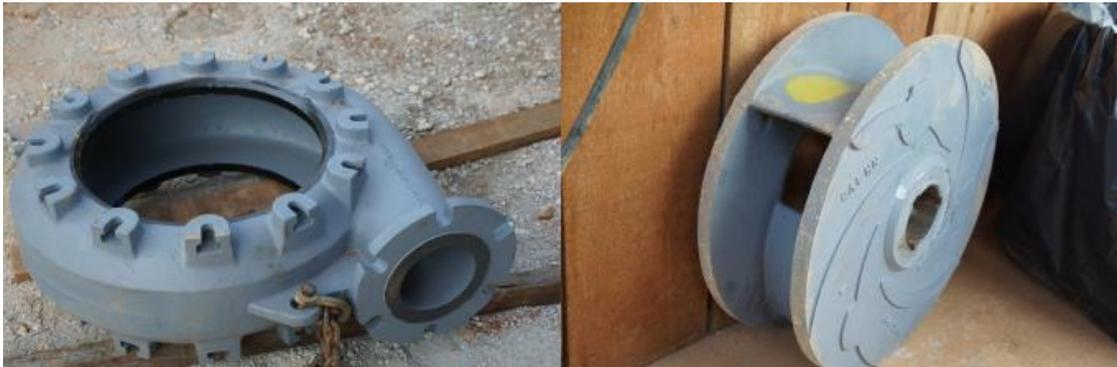
Figure 22 : corps de pompe et rotor (J.L. Nagel).
