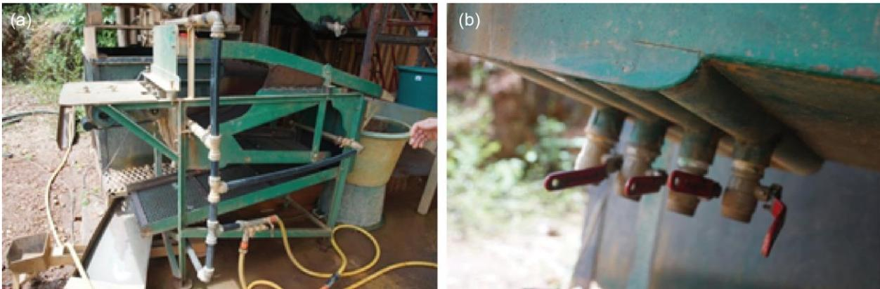
Figure 43 : crible vibrant et 5 sluices avec récupération de l'or ici à droite(J.L. Nagel)
