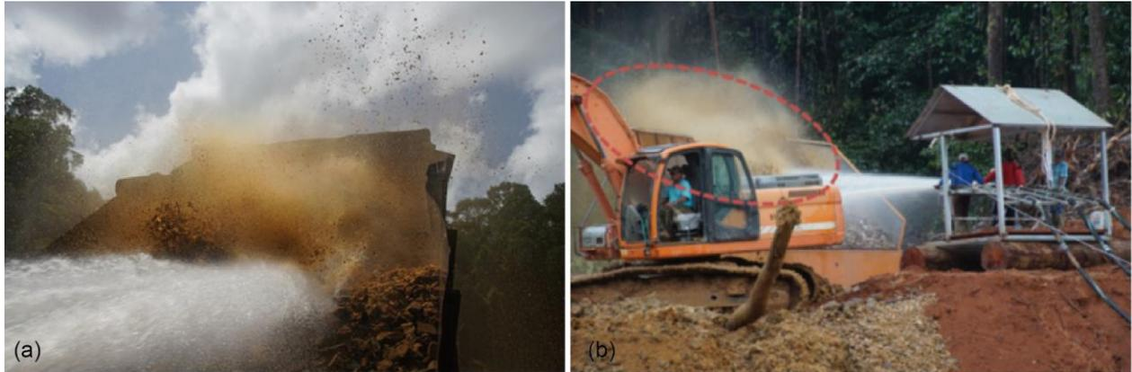
Figure 18 : photographies montrant les boulettes d'argile ejectées lors de la phase de débourage.
