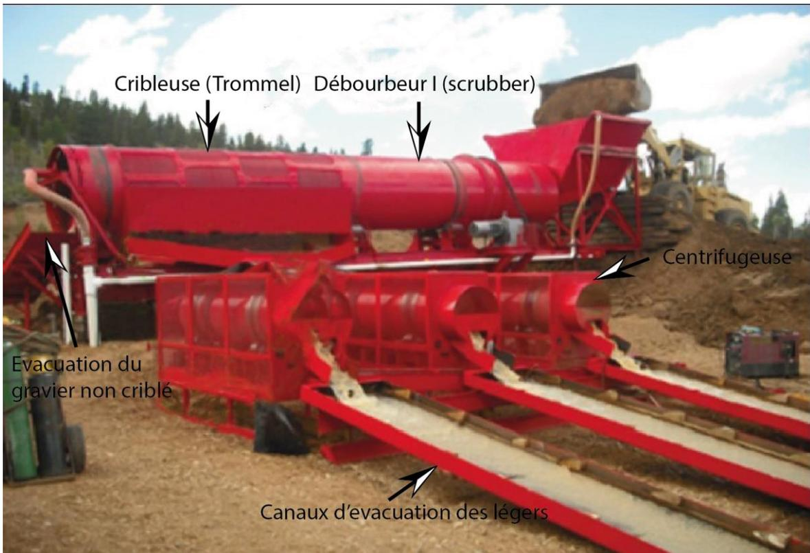
Figure 52 : exemple d'unité de traitement d'un minerai aurifère utilisée en Asie et en Indonésie du Sud (source : <http://www.alluvialgoldmachine.com>, modifié).
