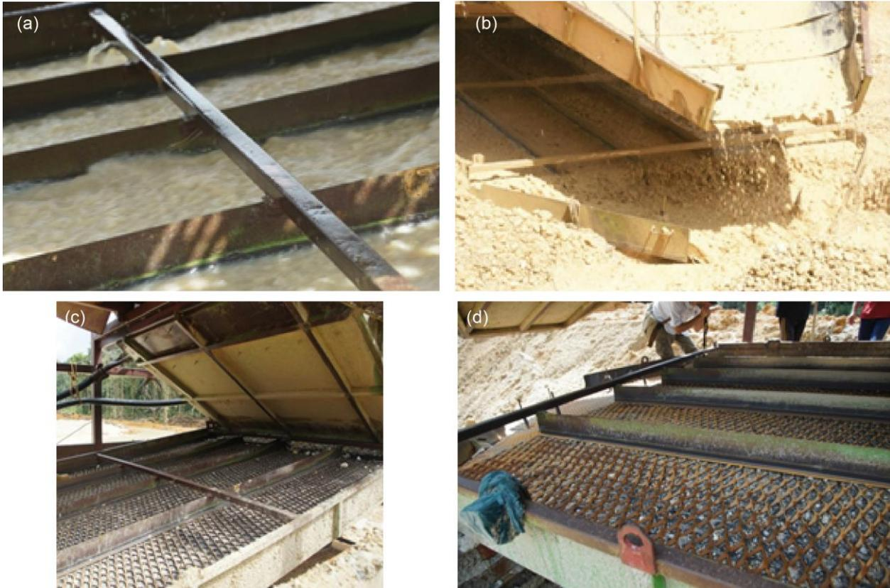
Figure 32 : (a et b) photographies de l'unité de piégeage en fonctionnement. Dans les deux cas, le flux est trop important et ne permet pas la sédimentation des minéraux lourds. (b et c) sluice à 4 canaux améliorant la répartition des écoulements (J.L. Nagel). A noter sur les photographies c et d la présence de barres transversales qui sécurisent le plan concentrateur.
