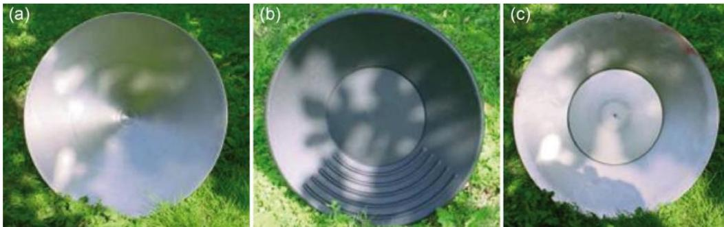
Figure 34 : formes diverses de récipients concentrateur. (a) batée, (b) pan rainuré californien, (c) plat finlandais (source : <http://www.orpaillage.fr>).
