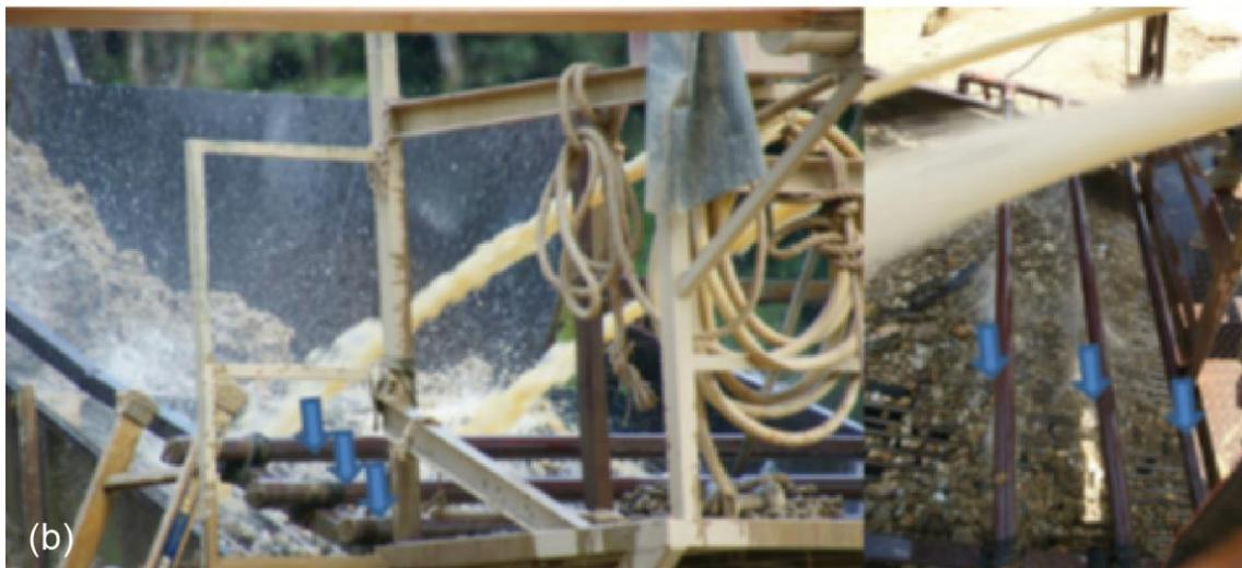
Figure 26 : (a) photographies de l'unité de criblage. (b) complément de lavage par trois tubes injecteurs fixes (J.L.Nagel)
