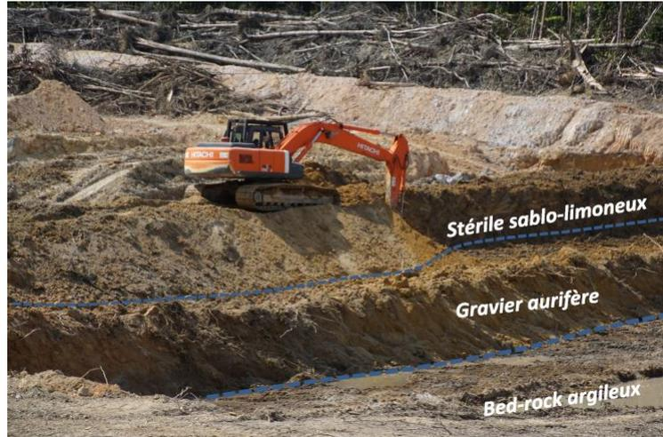
Figure 9 :Front de taille d'un flat aurifère, décapage du stérile et extraction du gravier minéralisé, façonnage de la digue (J.L.Nagel).
