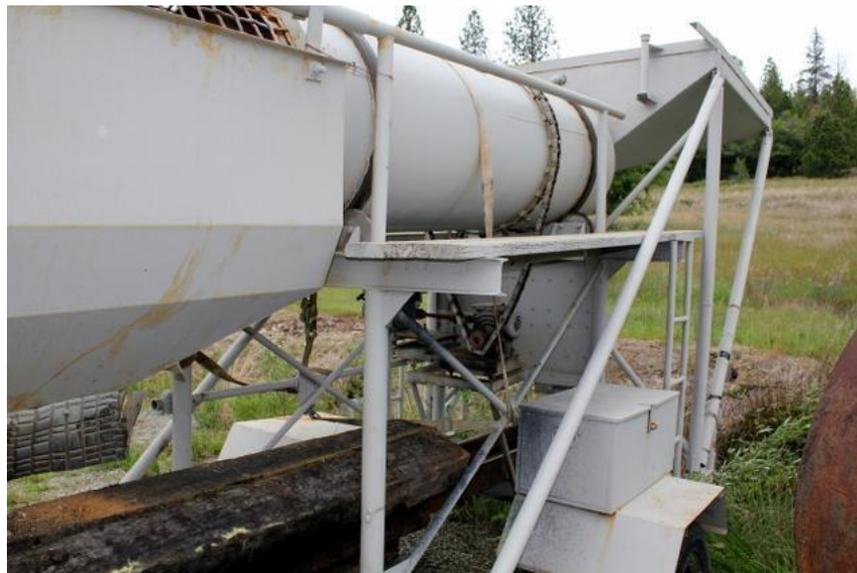
Figure 30 : Trommel à crible grillagé utilisé au Guatemala (Source : <https://riosuerte.com/>).
