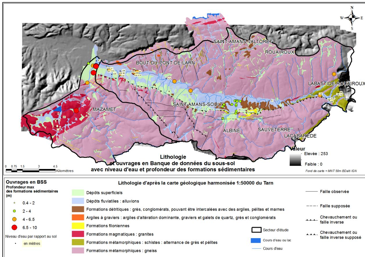
Illustration 7 : Ouvrages en BSS avec niveau d'eau et profondeur des formations sédimentaires.
