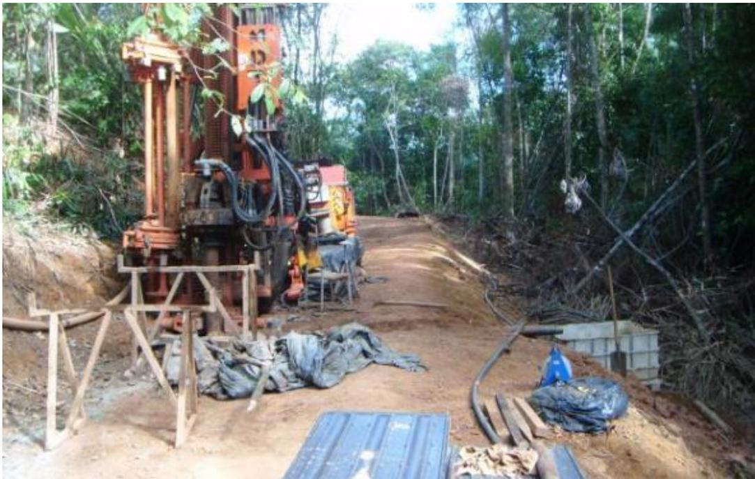
*Illustration 8. Photo du dispositif de mesure de débit avant soufflage du sondage SR1 (BRGM).*
