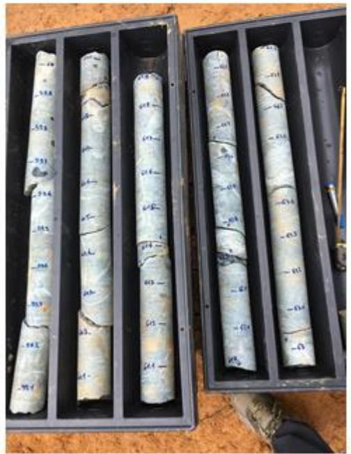
Illustration 21. Soufflage SR4 en cours de réalisation après équipement (a) et échantillons de roche obtenus entre 60 et 65 m de profondeur (b) – (BRGM).
